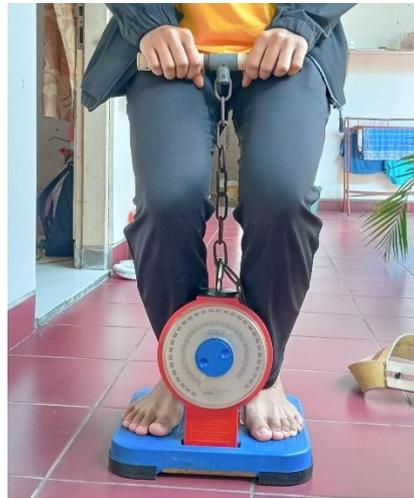
Berdasarkan beberapa pendapat ahli tersebut dapat disimpulkan bahwa terdapat tes untuk mengukur kekuatan otot tungkai pemain futsal, yaitu tes *leg and back dynamometer*. Dengan tes ini akan didapatkan hasil seberapa kuat otot tungkai pemain futsal.
