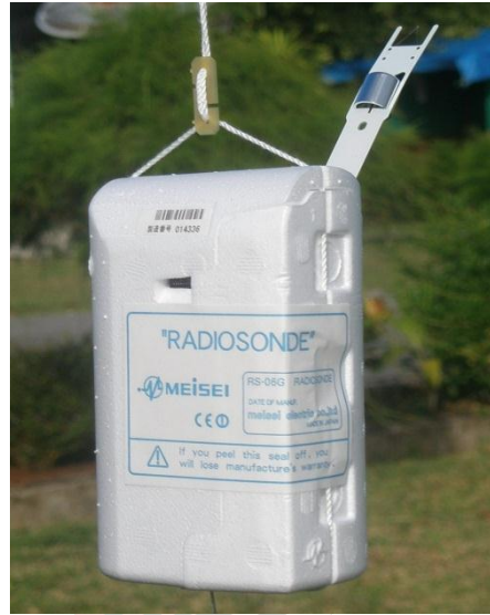
Gambar 2 : Payload Radiosonde RS-06G MEISEI
