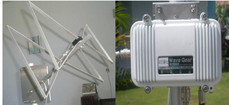
Gambar 3 : Rancangan antenna dan pre-amp
