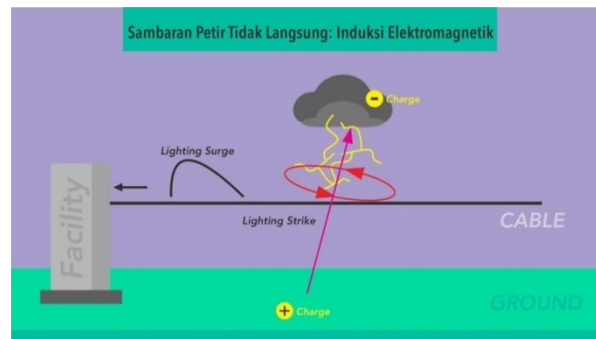
Gambar 20. Sambaran Petir dengan Induksi Elektromagnet
