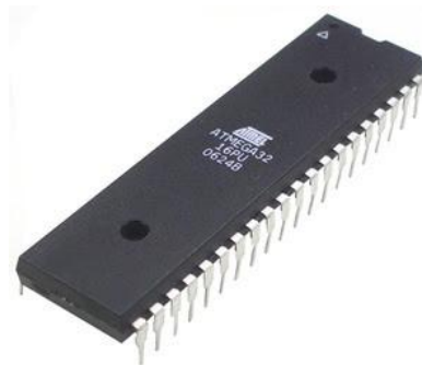
Gambar 2. IC mikrokontroler ATmega32 (Sumber: Purnomo, 2015)
