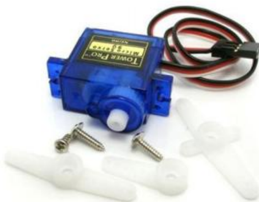
Gambar 4. Motor Servo SG90 (sumber : Handson Technology, Tanpa Tahun : 1)
