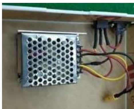
Gambar 19. Bagian Power Supply dan Converter AC to DC
