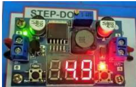
Gambar 26. Pengujian Modul Step-down
