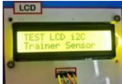
Gambar 28. Pengujian LCD 16x2
