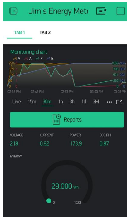
Gambar 28. Tampilan Monitoring Dashboard pada Pengukuran fasa T-N
