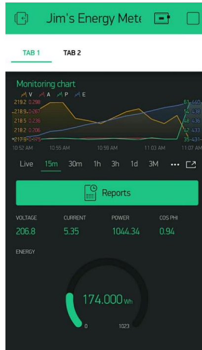
Gambar 27. Tampilan Monitoring Dashboard pada Pengukuran fasa S-N
