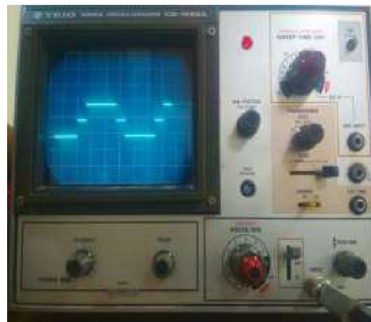
Lampiran 4. Perbandingan gelombang listrik output alat dengan inverter pabrikan
