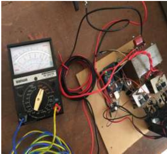
Lampiran 2. Proses pengujian dengan beban lampu LED 16 Watt
