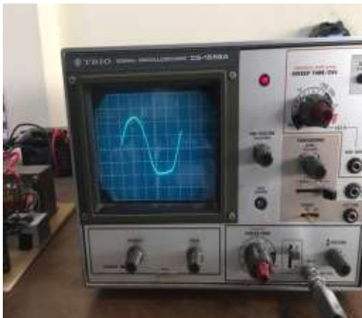
Lampiran 4. Perbandingan gelombang listrik output alat dengan inverter pabrikan
