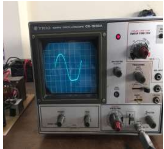
Lampiran 2. Proses pengujian dengan beban lampu LED 16 Watt
