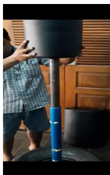
Gambar 23. Pemasangan Pipa Besi Spon dengan Pipa Besi Biru (Dokumen Pribadi)
