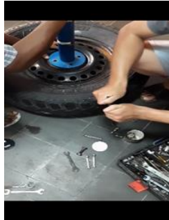
Gambar 21. Pemasangan Pipa Besi pada Velg Ban (Dokumen Pribadi)
