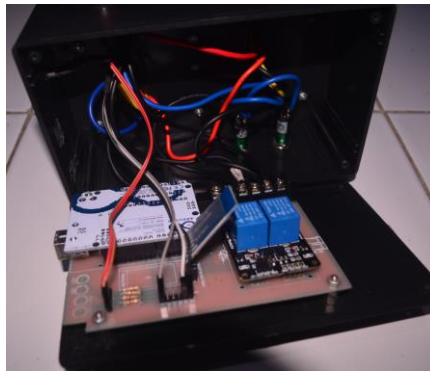
Gambar 23. Kendali Motor 3 Fasa Putar Kanan-Kiri Menggunakan Arduino Uno dan Modul Bluetooth HC-06
