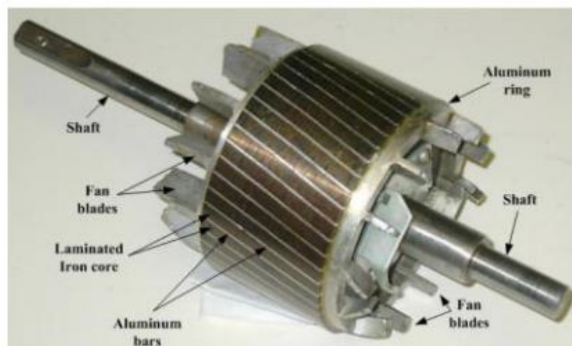
Gambar 4. Rotor Sangkar
