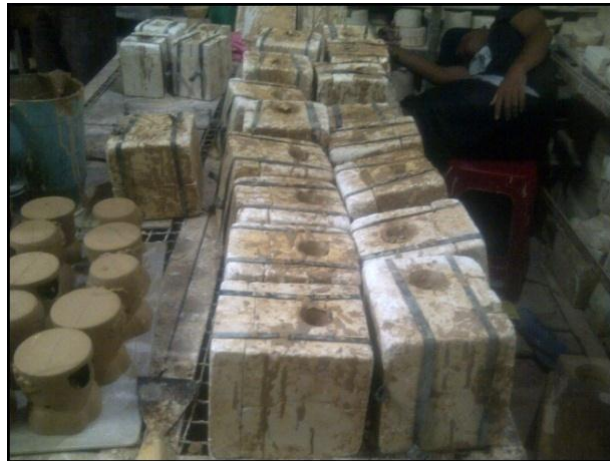
Gambar 33: Cetakan Gips Sumber: Dokumen Pribadi, 2015
