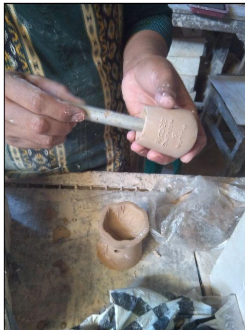
Gambar 39: Proses Melubang Bagian Bawah Biskuit Keramik
