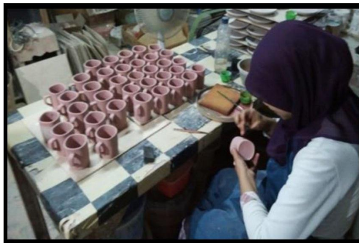
Gambar 42: Proses Pengglasiran Detail Motif
