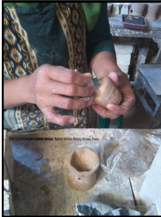
Gambar 38: Proses Melubang Bagian Atas Biskuit Keramik
