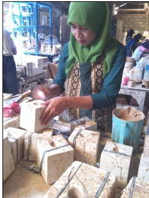
Gambar 36: Proses Membalikan Cetakan Gips
