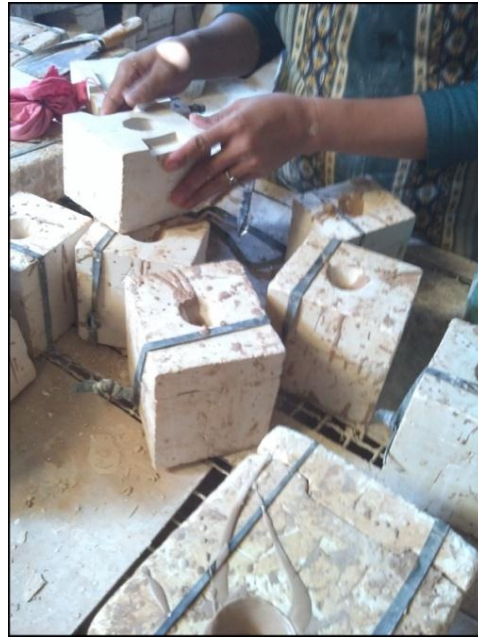
Gambar 37: Proses Pelepasan Cetakan dari Slip Tanah Liat Sumber: Dokumen Pribadi, 2015
