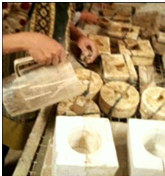
Gambar 35: Proses Penuangan Slip Tanah Liat kedalam Cetakan Sumber: Dokumen Pribadi, 2015
