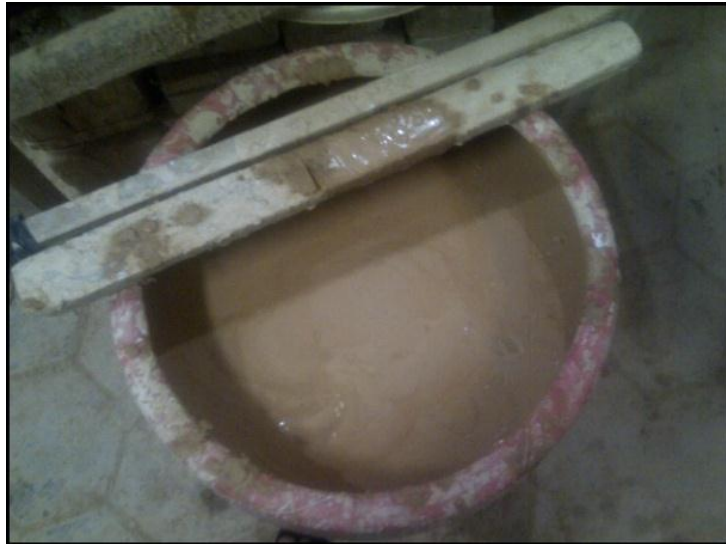
Gambar 34: Adonan Slip Tanah Liat Sumber: Dokumen Pribadi, 2015
