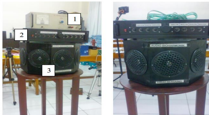
Gambar 4. Bagian-bagian ABHS Analog: 1. Power Supply; 2. Amplifier sumber bunyi dengan pilihan frekuensi; 3. Speaker (Kadarisman, 2012: 37)
