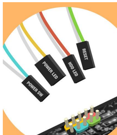
Gambar 10. Pemasangan kabel pada front panel header pada motherboard
