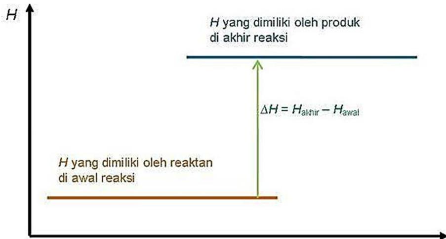
Gambar 2. Diagram tingkat energi reaksi endoterm
