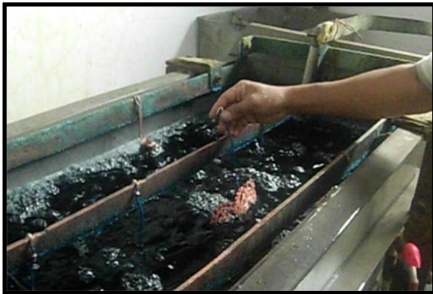
Gambar 31: Proses Pelapisan Tembaga Mengkilat (Dokumentasi Rahman FH, tanggal 24 Desember 2012)
