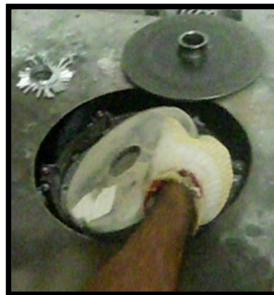
Gambar 14: Karet Cetakan Dimasukkan ke Mesin Casting Centrifugal (Dokumentasi Rahman FH, tanggal 24 Desember 2012)
