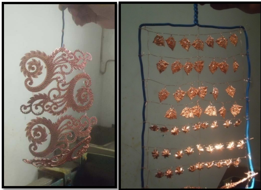
Gambar 32: Contoh Produk Setelah Pelapisan Tembaga Mengkilat (Dokumentasi Rahman FH, tanggal 24 Desember 2012)
