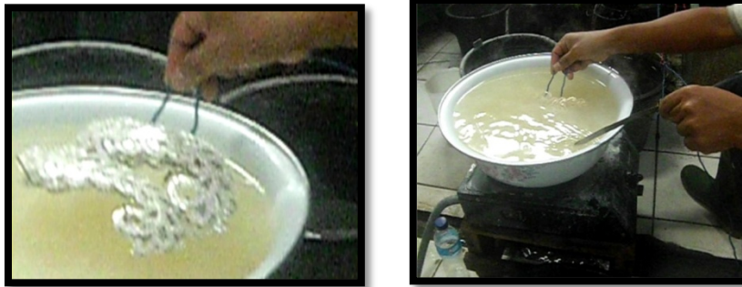
Gambar 43: Proses Pelapisan Emas (Dokumentasi Rahman FH, tanggal 24 Desember 2012)
