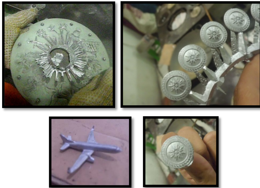
Gambar 16: Bentuk Produk Setelah Dicetak (Dokumentasi Rahman FH, tanggal 24 Desember 2012)
