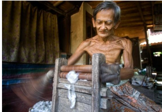
Gambar XXX. Proses Penggilasan Kapas Menggunakan Alat Penggilas Kapas (Sumber: Dokumentasi Ayuk, 20 Agustus 2014)
