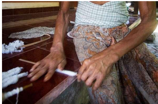
Gambar XXXI. Proses Penggilasan Kapas Menggunakan Tangan (Sumber: Dokumentasi Ayuk, 20 Agustus 2014)
