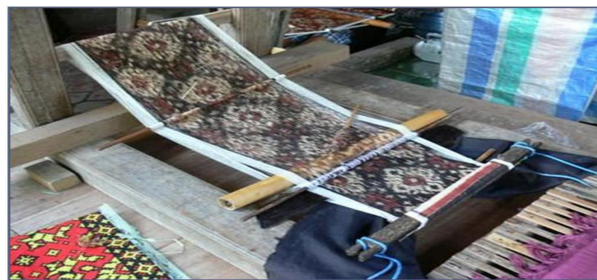
Gambar XXXVII. Susunan Benang yang Sudah Dihanai (Sumber: Dokumentasi Ayuk, 20 Agustus 2014)
