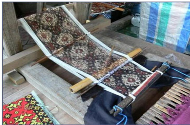
Gambar XVII. Alat Tenun Gendongan yang Sudah Dirangkai (Sumber: Dokumentasi Ayuk, 21 Agustus 2014)
