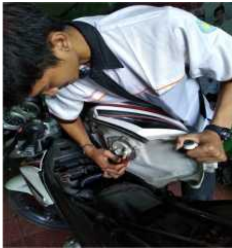
Gambar 16. Melepas Soket Selang Pompa
