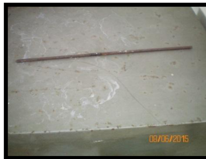
Gambar 25. Besi tulangan polos diameter 8 mm dan panjang 500 mm
