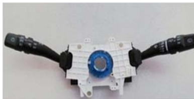
Gambar 4. Saklar wiper dan Washer (Anonim, 1995: 212).
