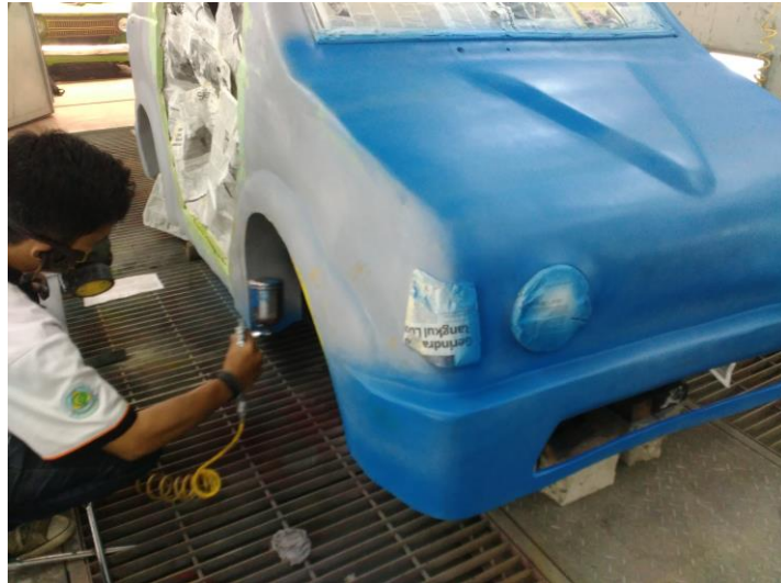
Gambar 29. Proses Pengecatan Warna
