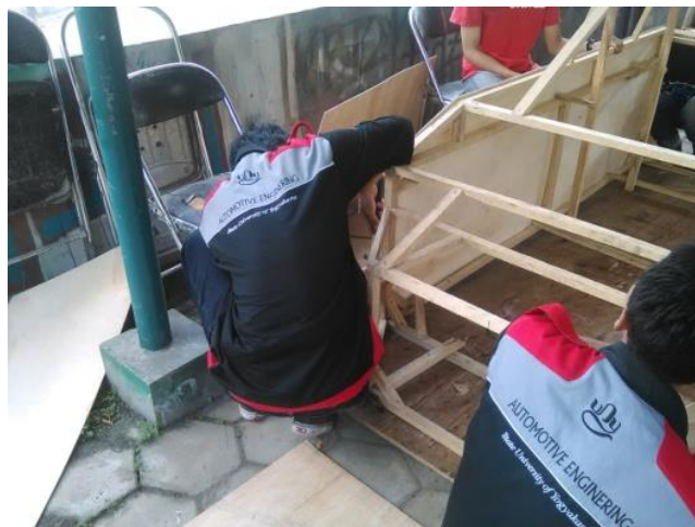
Gambar 21. Pemasangan Triplek Pada Rangka Cetakan
