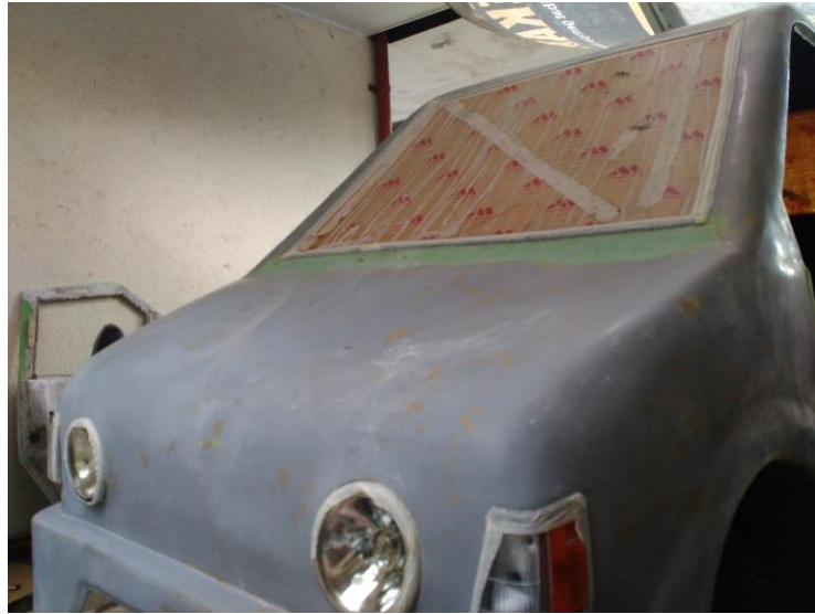
Gambar 27. Bodi Kendaraan Setelah di Epoxy
