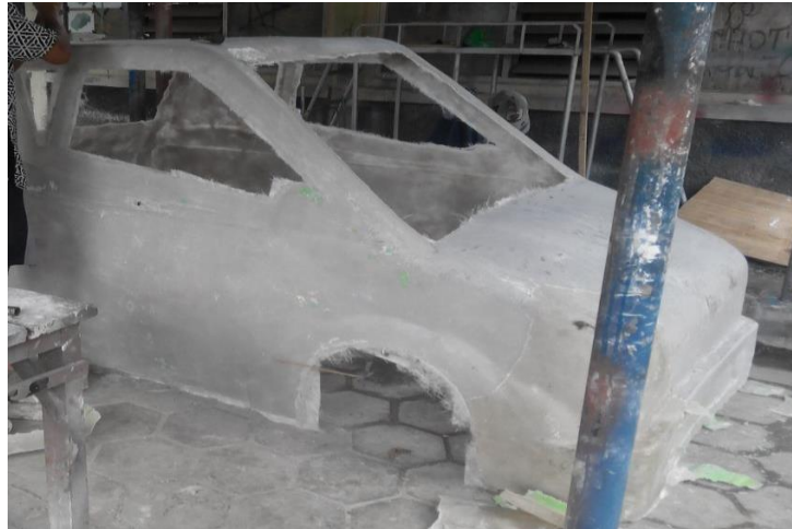
Gambar 25. Bodi Kendaraan Setelah Di Cetak
