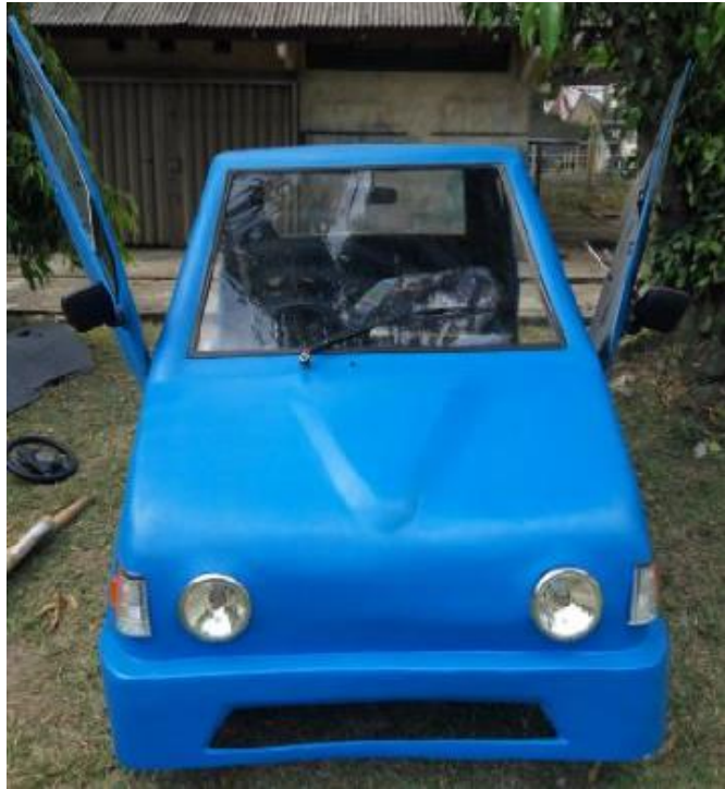
Gambar 41. Hasil Pembuatan Bodi Depan
