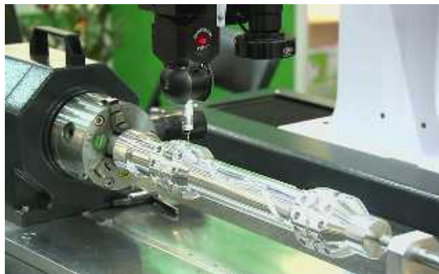
Gambar 8. Pengukuran dengan mesin ukur koordinat
