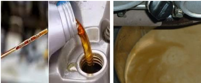
Gambar 2. Oli Baru/Tidak Terkontaminasi (Kiri) dan Oli yang Terkontaminasi (Kanan)
