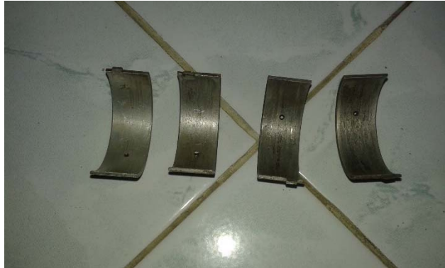
Gambar 40. Kondisi tidak lengkapnya bantalan connecting rod
