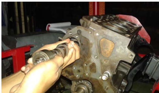
Gambar 52. Pemasangan poros kam
