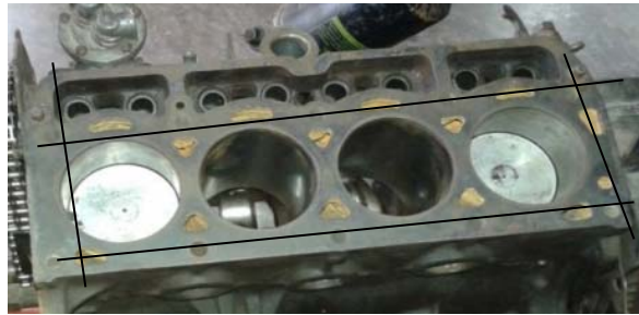
Gambar 42. Sisi pemeriksaan permukaan blok silinder
