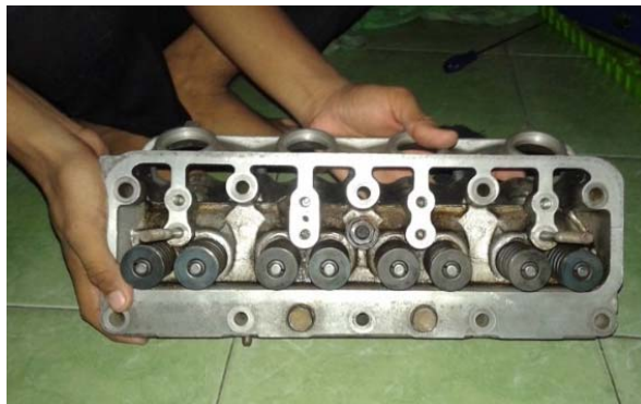
Gambar 55. Kepala silinder sesudah komponen katup dan pegas katup dipasang
