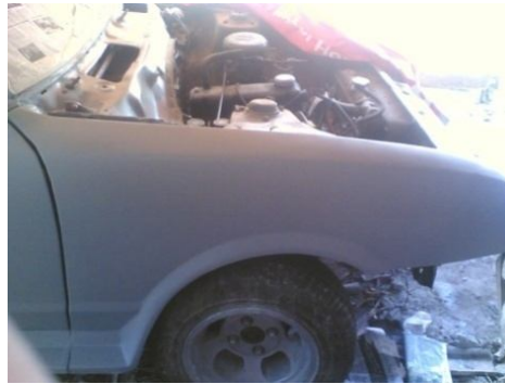
Gambar 31. Aplikasi Epoxy Surfacer
