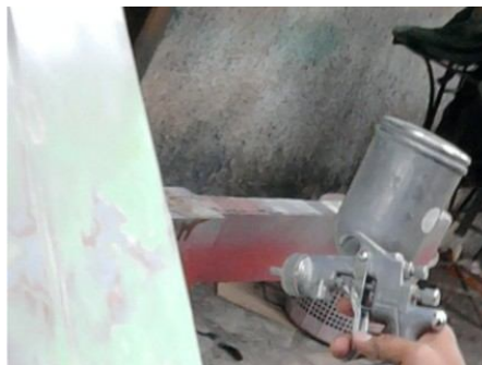
Gambar 30. Proses Aplikasi Surfacer
