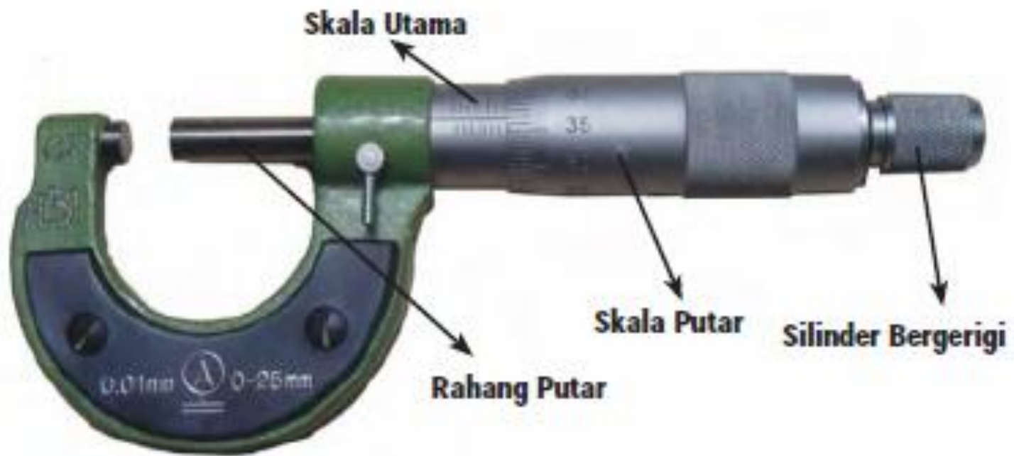
Gambar 1.17 Bagian-Bagian Mikrometer Sekrup Sumber Gambar: www.phy.uct.ac.za (2008)
