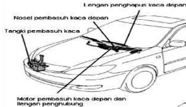
Gambar 1. Konstruksi sistem wiper depan (Anonim, t.th, 447)
