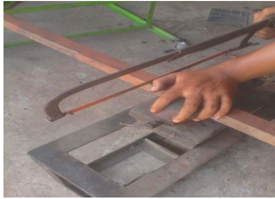
Gambar 21. Pemotongan Batang Komponen Menggunakan Gergaji Besi
