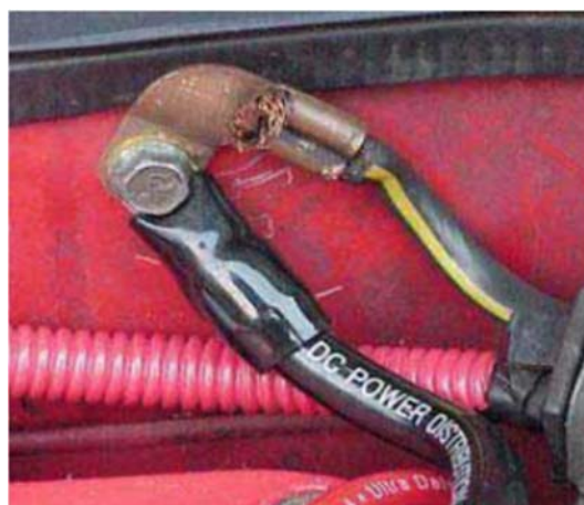
Gambar 6. Baut Massa Pada Bodi (Gunadi, 2008: 415)
