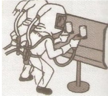
Gambar 19. Posisi badan dalam menggerakkan spray gun (Gunadi, 2008: 502)
