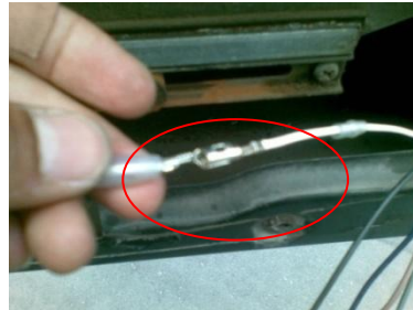
Gambar 35. Merangkai Kabel Unit Central Door Lock
