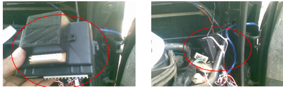
Gambar 32. Memasang Main Board dan Module
