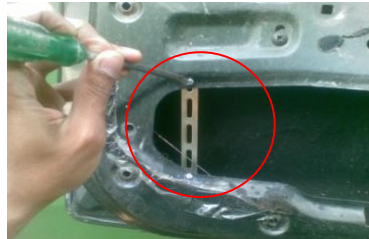
Gambar 30. Memasang Batang Dudukan Motor
