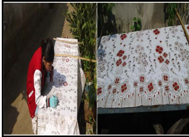
Gambar C : Proses pewarnaan menggunakan pewarna rapid (Sumber: Dokumentasi Putri Utami, Agustus 2015)
