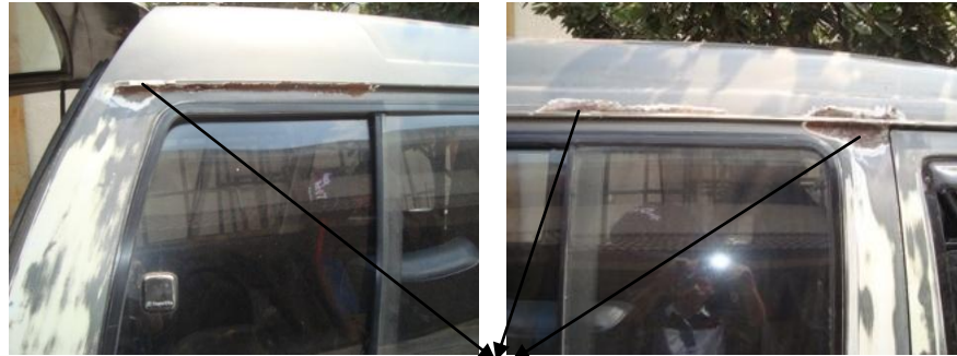
Dempul talang air bagian atas dan bawah bagian kanan sudah rapuh Gambar 48. Kerusakan Pada Bagian Kanan
