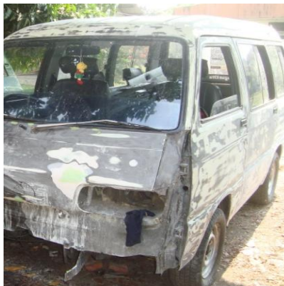
Gambar 53. Body Mobil Setelah Pengupasan Cat
