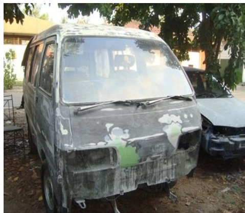
Gambar 54. Body Mobil Setelah Pendempulan
