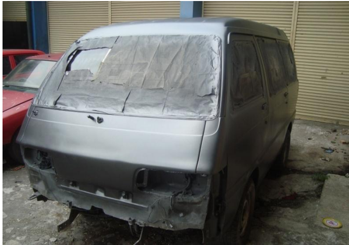
Gambar 62. Hasil Pengecatan Dasar
