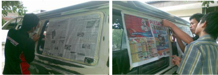
Gambar 59. Proses Masking Kendaraan
