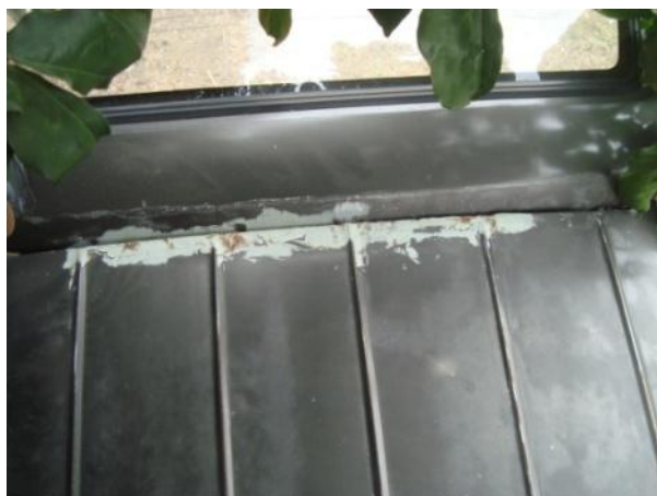
Gambar 53. Pada Atap Kendaraan, Dempul sudah Mengelupas dan Cat Memudar
