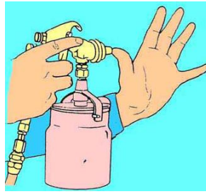
Gambar 42. Jarak Pengecatan (Gunadi. 2008: 491)
