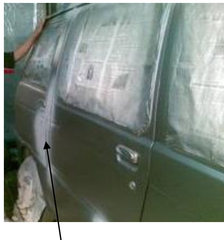
Gambar 63. Perataan Permukaan Pada Cat Dasar
