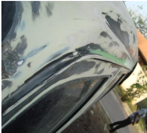
Gambar 57. Pendempulan Pada Talang Air
