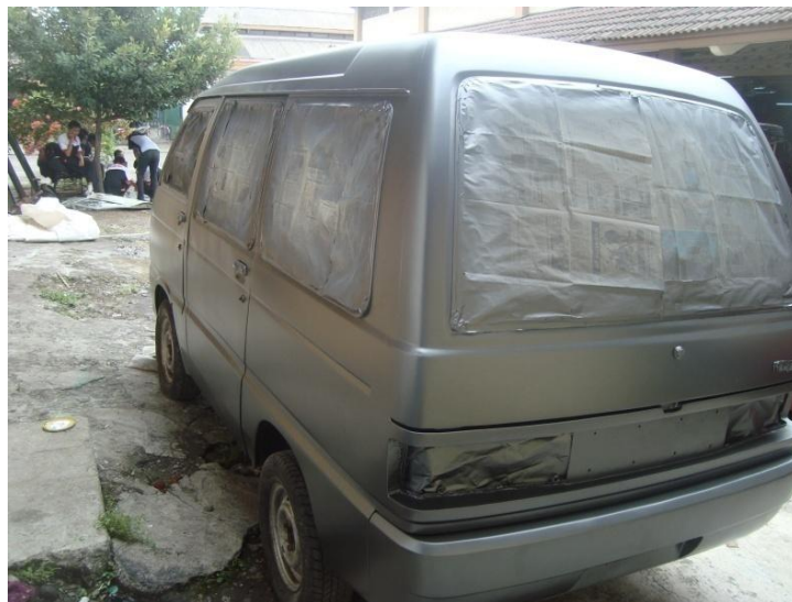
Gambar 64. Cat Lapisan Atas Pada Kendaraan.
