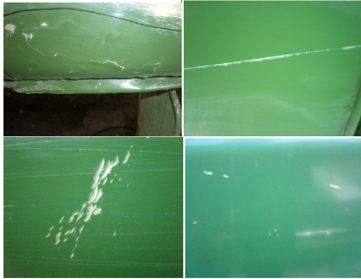
Gambar 28. Kerusakan cat pada bodi bagian kanan
