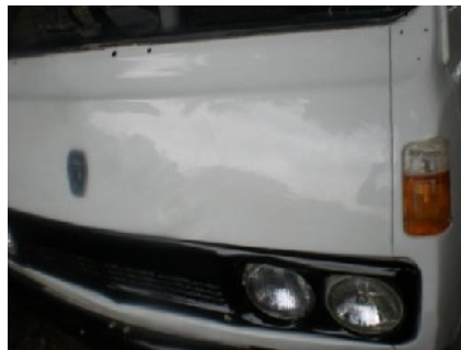
Gambar 38. Hasil bagian depan bodi setelah perbaikan bodi dan pengecatan ulang.
