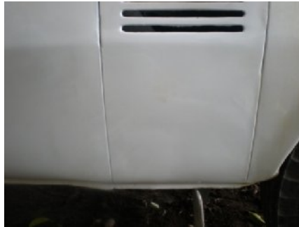
Gambar 39. Hasil perbaikan bodi dan pengecatan ulang bodi sebelah kanan yang mengalami pengeroposan.
