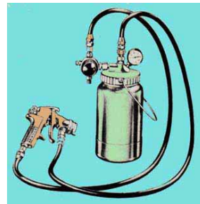
Gambar 12. Spray gun tipe kompresi (Gunadi, 2008:469)
