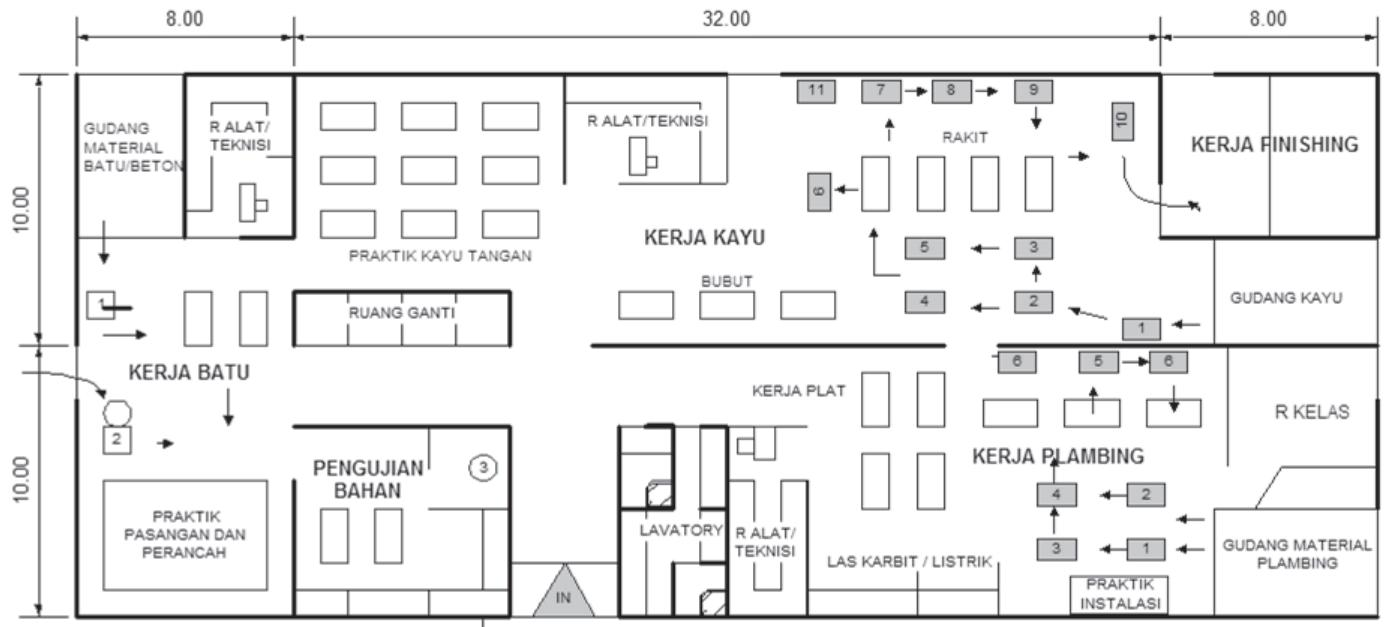
Gambar 1. *Layout standar penataan bengkel batu dan beton*
