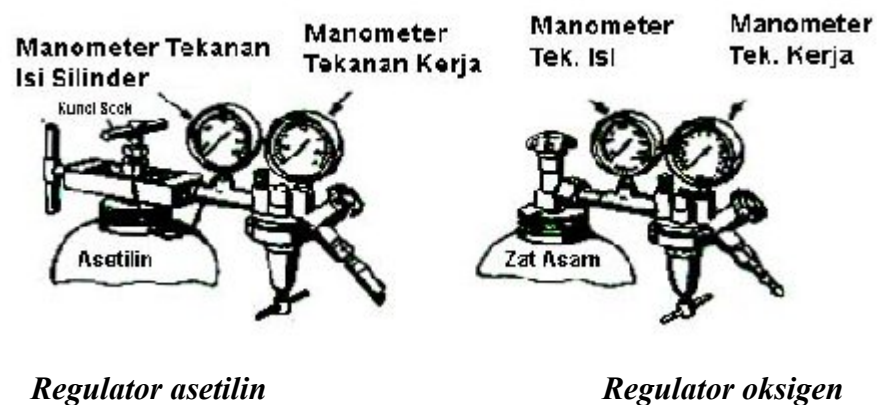
Gambar 3. Regulator Asetilin dan Oksigen (Jaenudin, 2004:30)
