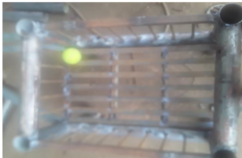
Gambar: 16 Proses pembuatan Keranjang besi
