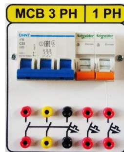
Gambar 19. Realisasi interface MCB 1 fasa dan 3 fasa
