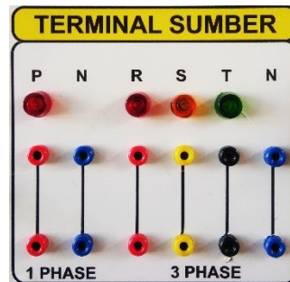
Gambar 18. Realisasi interface terminal sumber
