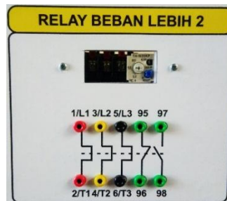
Gambar 25. Realisasi interface relai beban lebih
