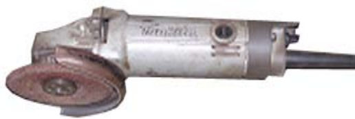
Gambar 24. Gerinda Tangan Sumber: dokumentasi pribadi, 2011
