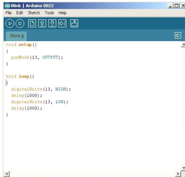
Gambar 2. Tampilan Program pada Software Arduino IDE
