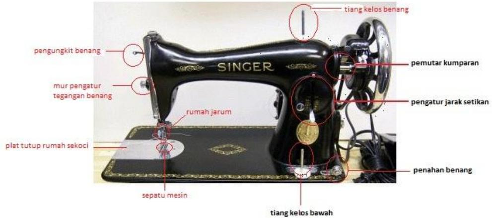
Gambar 2. Komponen Mesin Jahit manual
