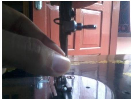
Gambar 3. Memasang Jarum Mesin
