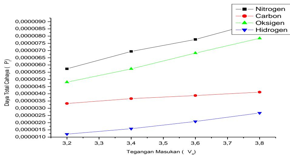
Gambar 23. Grafik Hubungan Tegangan Masukan dan Daya Total pada Gas Nitrogen, Oksigen, Karbondioksida, dan Hidrogen
