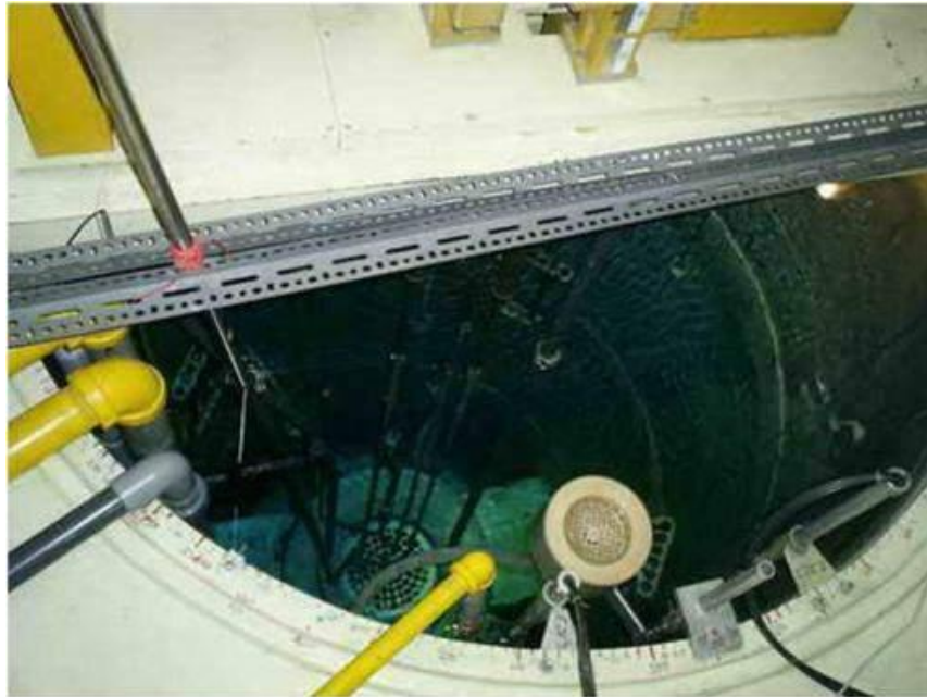
Gambar 6. Teras Reaktor Kartini (sumber :wordpress.com)
