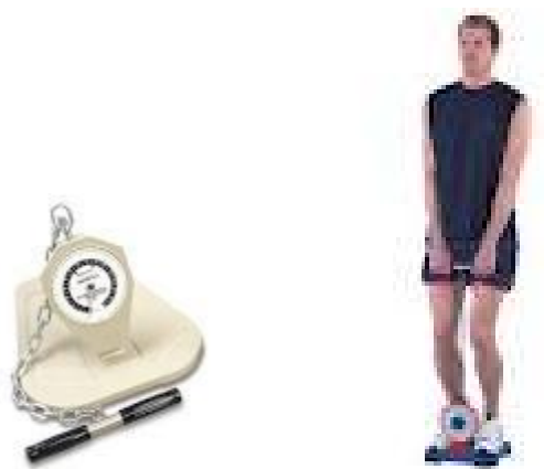
Gambar 4 : Back and leg dynamometer dan Cara Mengukur Kekuatan Otot Punggung
