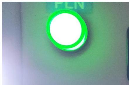
**Gambar 10.** Bentuk Fisik Pilot Lamp
