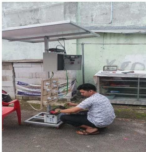
**Gambar 18.** Test pengisian *accu* dengan PV
