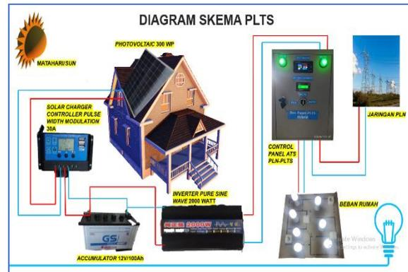
**Gambar 12.** Diagram Skema PLTS dengan sistem ATS
