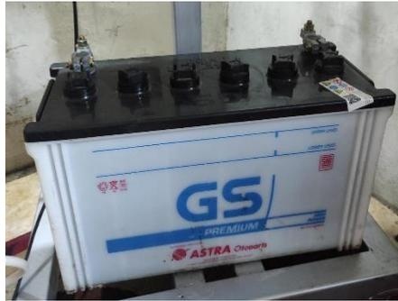
**Gambar 11.** Bentuk Fisik Accu basah
