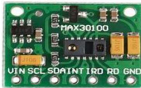
Gambar 9. Sensor BPM ( max30100 pulse oximeter heart-rate sensor module ) (Sumber: Dokumentasi Pribadi)
