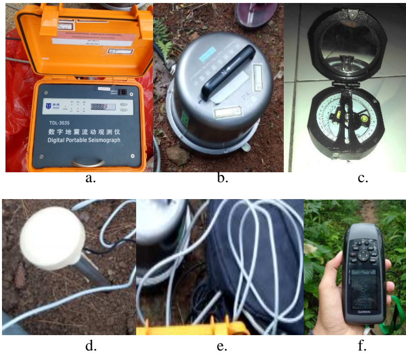
Gambar 6. Digital Portable Seismograph (a) Digitizer (b) Seismometer dan (c) Kompas (d) Antena GPS (e) Kabel Penghubung (f) GPS
