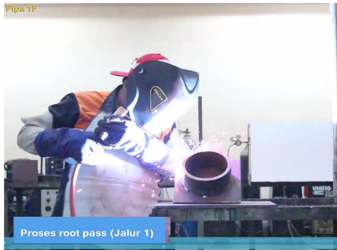
**Gambar 28. Contoh Screenshot Tampilan Video Proses Las SMAW sambungan pipa dengan plat posisi 1F.**
