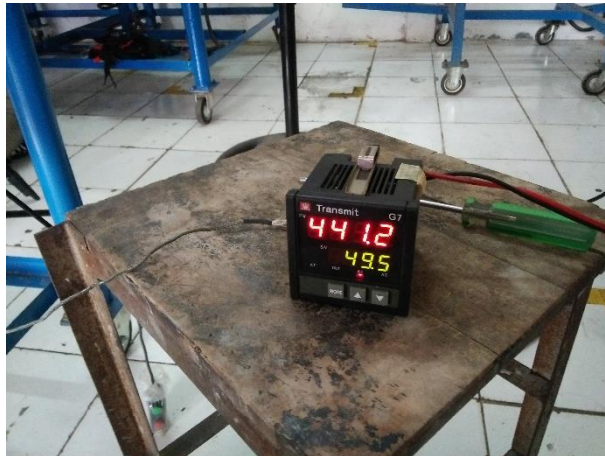
Gambar 5. Pengujian Temperatur Gas Buang Mesin Toyota Kijang Tipe 7K
