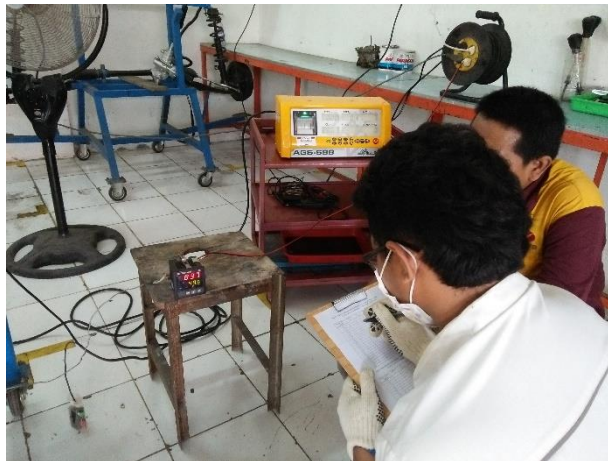
Gambar 5. Mengukur Temperatur Gas Buang Dengan Menggunakan Digital Thermometer
