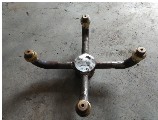
Gambar 3. Pembuatan Nozzle Oil Filter Cleaner
