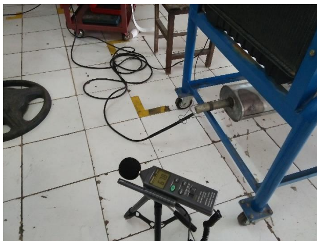
Gambar 5. Mengukur Temperatur Gas Buang Dengan Menggunakan Digital Thermometer
