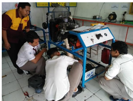
Gambar 3. Pemasangan Exhaust Wrap Pada Knalpot Mesin Toyota Kijang Tipe 7K
