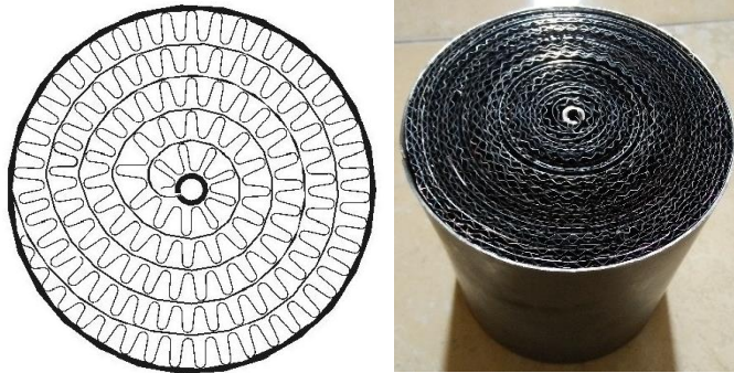
Gambar 131. Metallic Catalytic Converter Berbahan Dasar Plat Tembaga Berlapis Krom Dengan Tinggi Lekukan 2 mm
