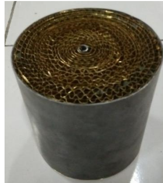
Gambar 52. Metallic Catalytic Converter Berbahan Dasar Plat Kuningan Dengan Tinggi Lekukan 2 mm
