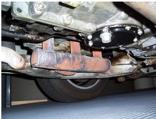
Gambar 34. Posisi Reaktor Panas Pada Mobil (Bagian 2) Sumber: http://www.google.co.id/imgres?q=thermal+reactor
