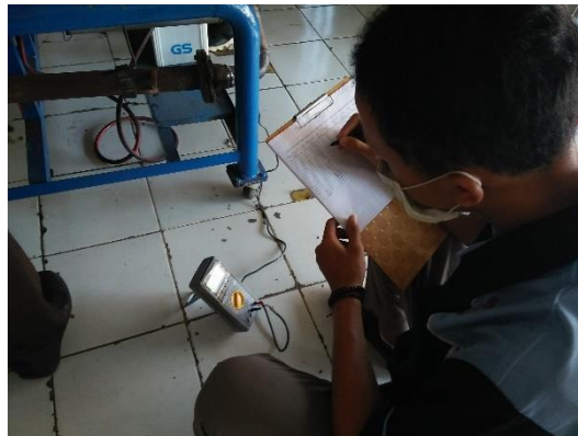
Gambar 2. Pengujian Temperatur Gas Buang Pada Knalpot Mesin Toyota Kijang Tipe 5K
