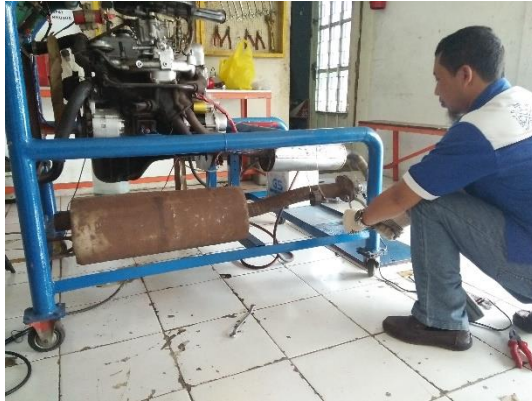
Gambar 1. Pemasangan Off-Set Tube Type Muffler Pada Knalpot Mesin
