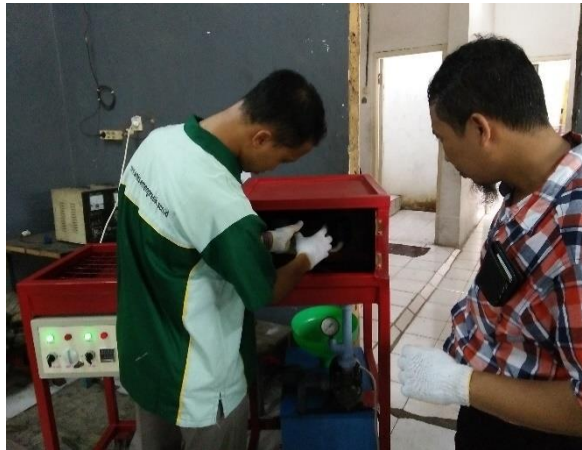
Gambar 1. Memasang Oil Filter Bekas ke dalam Nozzle
