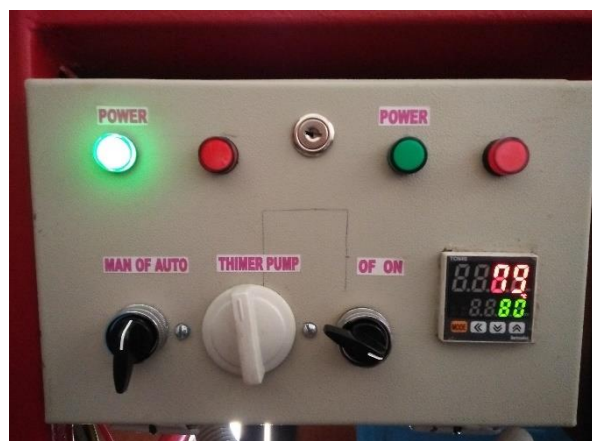
Gambar 3. Mengatur Temperatur Pembersihan Oil Filter Bekas Sebesar 80°C
