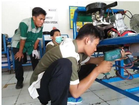
Gambar 2. Pemasangan Thermocouple Pada Knalpot
