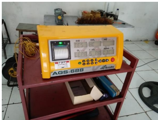
Gambar 2. Exhaust Gas Analyzer Untuk Mengukur Emisi Gas Buang Mobil Bensin
