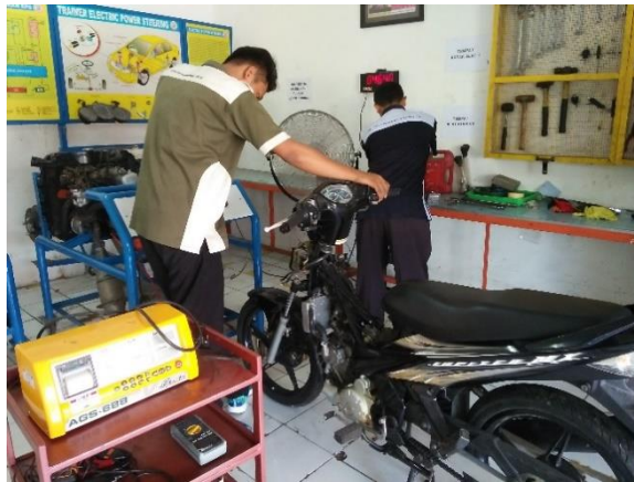
Gambar 1. Uji Emisi Gas Buang Knalpot Eksperimen Yamaha Jupiter MX
