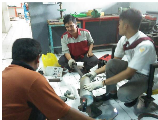
Gambar 3. Penyambungan Elbow Pipa Gas Buang
