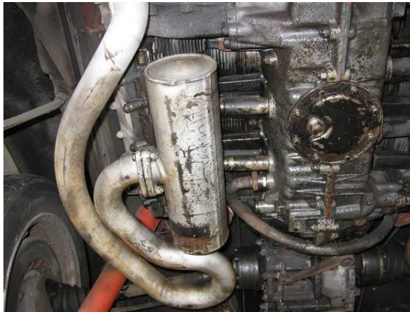
Gambar 33. Posisi Reaktor Panas Pada Mobil (Bagian 1) Sumber: http://www.google.co.id/imgres?q=thermal+reactor
