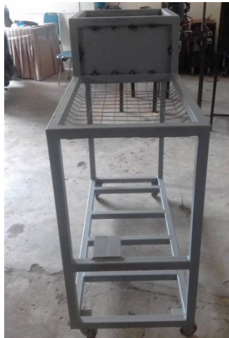
Gambar 2. Pemberian Cat Dasar Pada Rangka Oil Filter Cleaner
