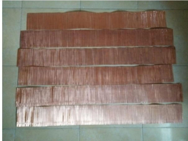
Gambar 7. Hasil Pembuatan Tinggi Lekukan 2 mm Pada Plat Tembaga
