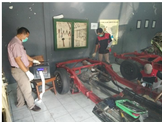
Gambar 5. Mengukur Opasitas Gas Buang dan Kebisingan Mesin Isuzu C190
