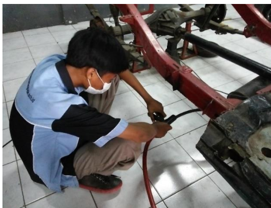
Gambar 3. Memasukkan Gas Probe ke dalam Knalpot Standar Untuk Mengukur Opasitas Gas Buang
