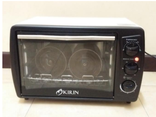
Gambar 14. Proses Kalsinasi Metallic Catalytic Converter Plat Tembaga Berlapis Krom Pada Temperatur 120^{\circ}\text{C} Selama 12 Jam dan 550^{\circ}\text{C} Selama 6 Jam
