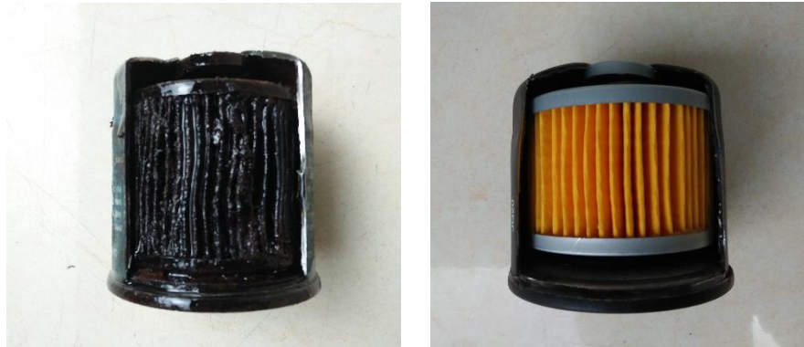
Gambar 104. Kondisi Saringan Oli Mesin Bekas ( Used Oil Filter ): (a) Sebelum Pembersihan, (b) Setelah Pembersihan Dengan Menggunakan Oil Filter Cleaner Selama 10 Menit Dengan Temperatur Air 90°C dan Tekanan 0,7 kg/cm 2
