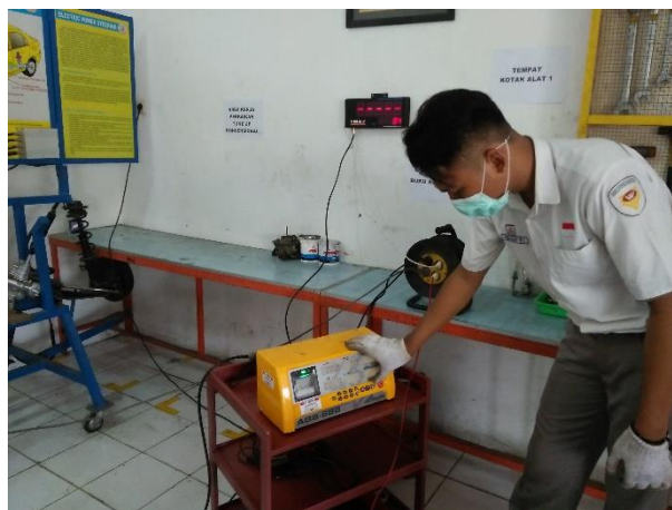
Gambar 6. Pengujian Emisi Gas Buang Mesin Toyota Kijang Tipe 7K
