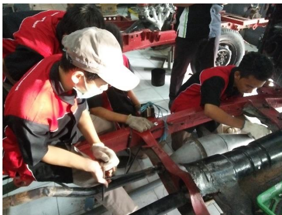
Gambar 2. Memasang Knalpot Mobil Diesel Isuzu C190
