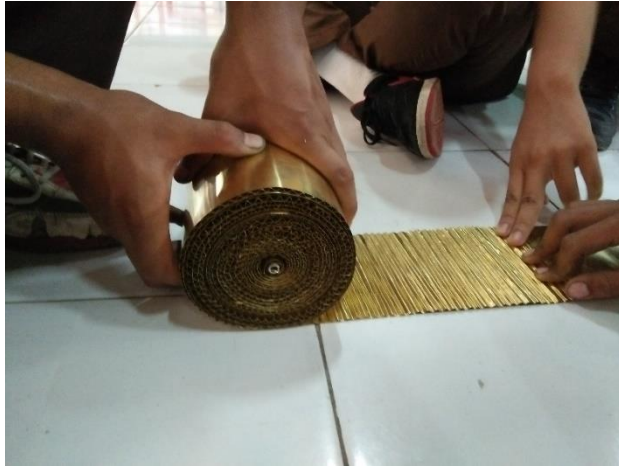
Gambar 10. Penggulungan Lekukan Plat Kuningan Sebagai Metallic Catalytic Converter
