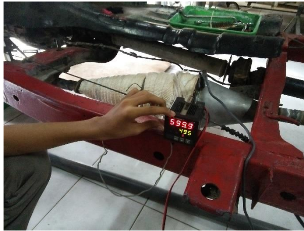
Gambar 4. Mengukur Temperatur Gas Buang Dengan Digital Thermometer
