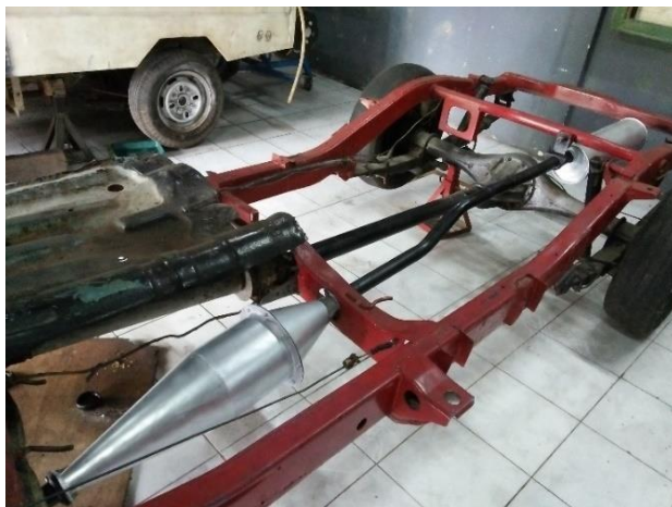
Gambar 160. DPF Casing dan Muffler Mesin Isuzu C190 di SMK Semen Gresik Setelah Pengecatan
