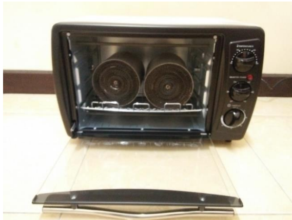
Gambar 13. Proses Kalsinasi Metallic Catalytic Converter Plat Tembaga Berlapis Krom Pada Temperatur 100^{\circ}\text{C} Selama 30 Menit
