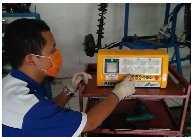
Gambar 6. Pengujian Emisi Gas Buang Mesin Toyota Kijang Tipe 5K
