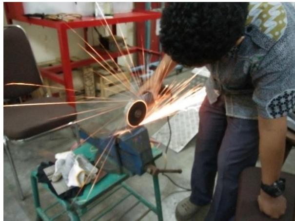
Gambar 8. Pembuatan Pin Metallic Catalytic Converter dari Pipa Stainless Steel
