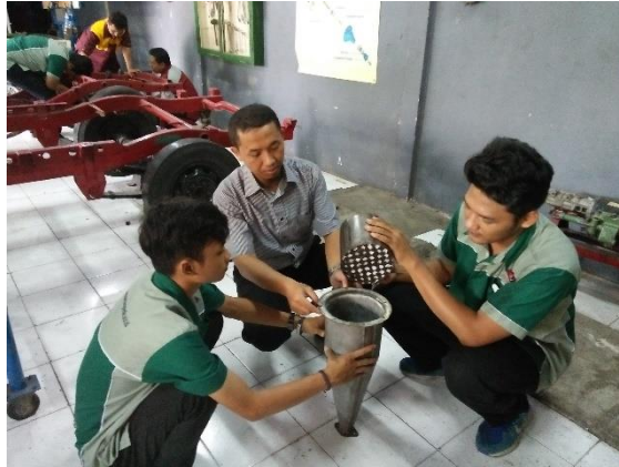
Gambar 1. Memasukkan DPF Stainless Steel + 110 gr Glasswool ke dalam Casing
