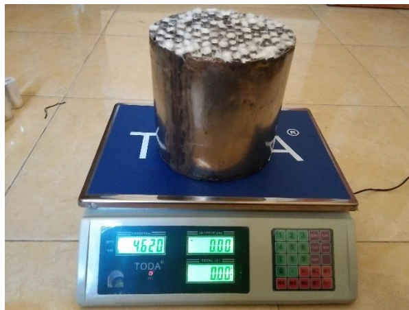
Gambar 8. Menimbang DPF Pada Timbangan Digital
