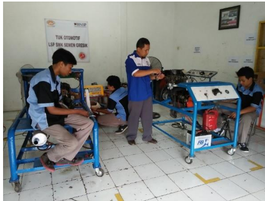
Gambar 1. Proses Pengambilan Data Emisi Gas Buang, Tingkat Kebisingan, Putaran Mesin, dan Temperatur Knalpot Standar Mesin Toyota Kijang Tipe 5K
