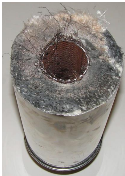
Gambar 76. Straight-Through Type Muffler dengan Penambahan 1000 gr Glasswool
