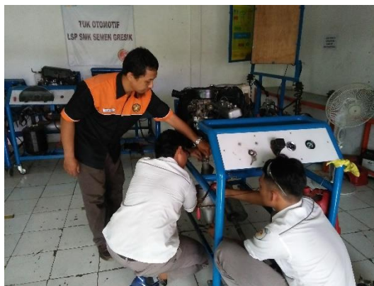
Gambar 2. Pemasangan Metallic Catalytic Converter Kuningan ke dalam Knalpot Mesin Toyota Kijang Tipe 7K
