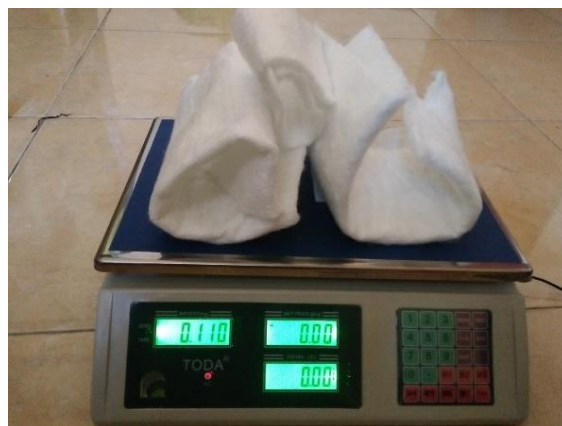
Gambar 67. Penimbangan Glasswool Sebesar 110 gr Menggunakan Timbangan Digital
