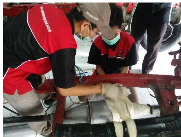
Gambar 3. Memasang Exhaust Wrap Pada DPF Casing
