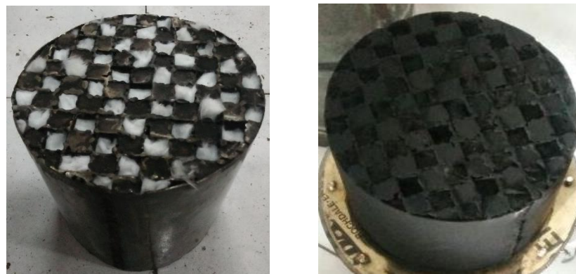
Gambar 95. DPF Berbahan Dasar Plat Stainless Steel dan 110 gr Glasswool : (a) Sebelum Pengujian, (b) Setelah Pengujian
