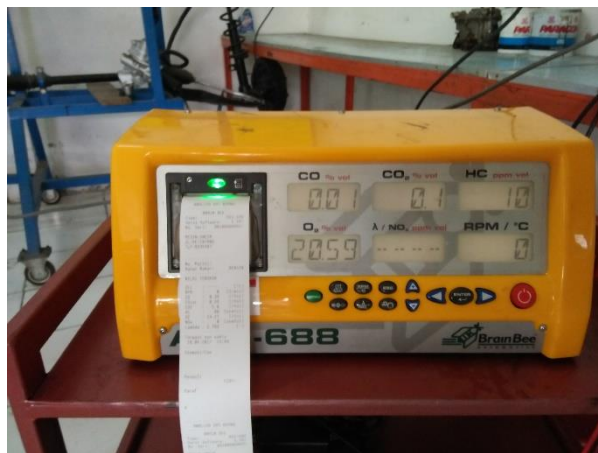
Gambar 8. Emisi Gas Buang yang Terukur di Exhaust Gas Analyzer
