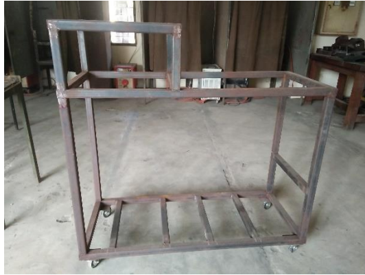
Gambar 1. Pembuatan Rangka Oil Filter Cleaner
