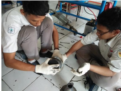
Gambar 1. Pemasangan Metallic Catalytic Converter Cu+Cr ke dalam Casing
