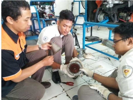
Gambar 1. Pemasangan Metallic Catalytic Converter Tembaga ke dalam Casing
