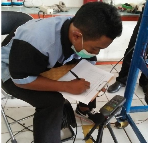
Gambar 4. Pengujian Kebisingan Mesin Toyota Kijang Tipe 5K
