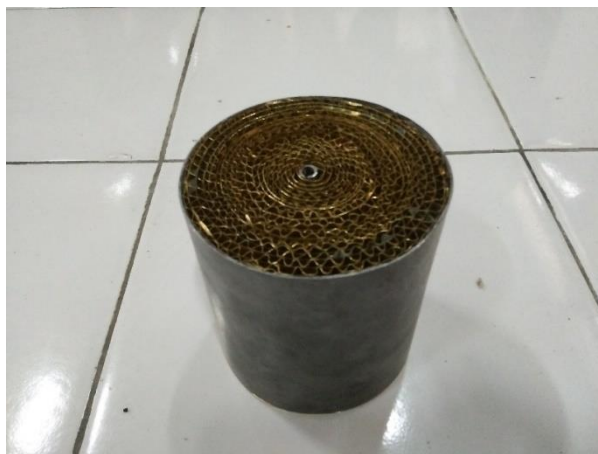
Gambar 12. Metallic Catalytic Converter Berbahan Dasar Plat Kuningan
