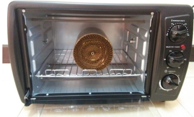
Gambar 13. Proses Kalsinasi Metallic Catalytic Converter Plat Kuningan Pada Temperatur 100°C Selama 30 Menit
