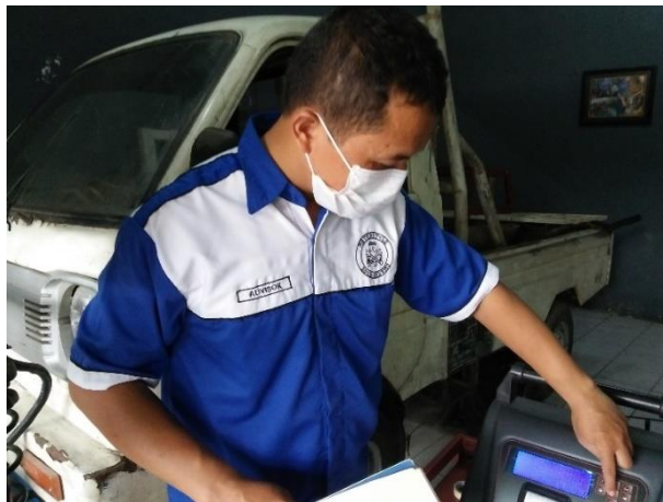
Gambar 5. Mengukur Opasitas Gas Buang Mesin Isuzu C190
