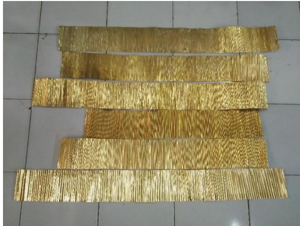
Gambar 7. Hasil Pembuatan Tinggi Lekukan 2 mm Pada Plat Kuningan
