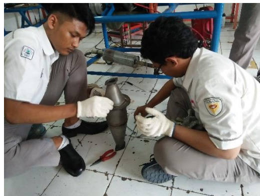
Gambar 2. Pemasangan Metallic Catalytic Converter Tembaga ke dalam Knalpot Mesin Toyota Kijang Tipe 7K
