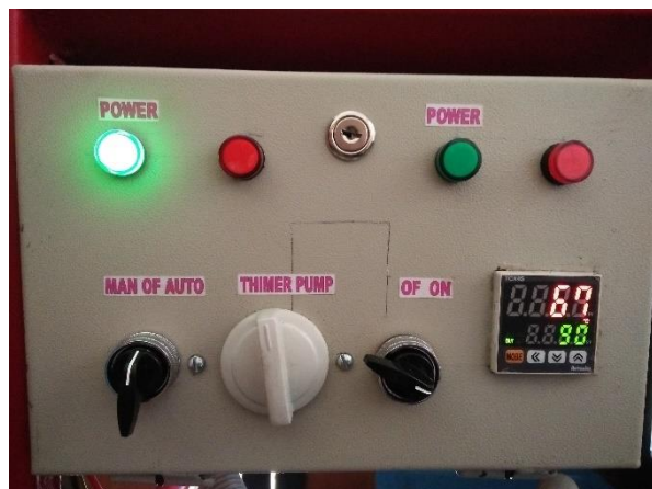
Gambar 3. Mengatur Temperatur Pembersihan Oil Filter Bekas Sebesar 90°C
