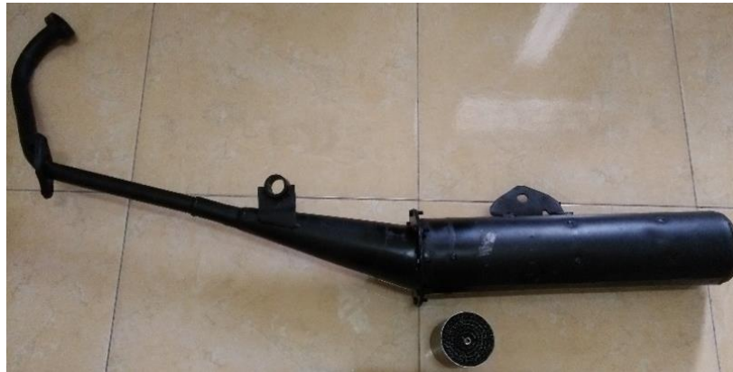
Gambar 1. Knalpot Eksperimen Yamaha Jupiter MX Dengan Catalytic Converter
