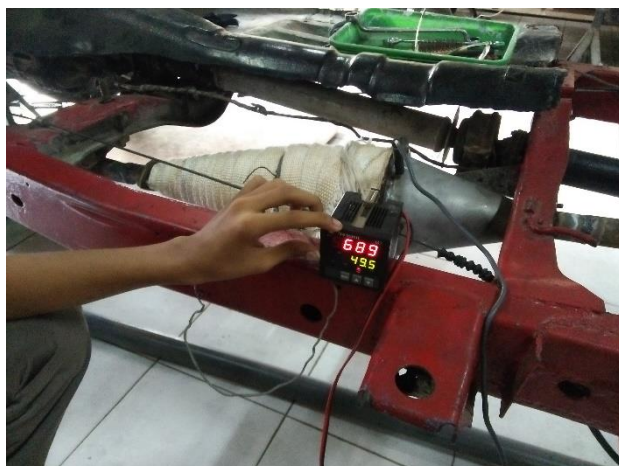
Gambar 4. Mengukur Temperatur Gas Buang Dengan Digital Thermometer
