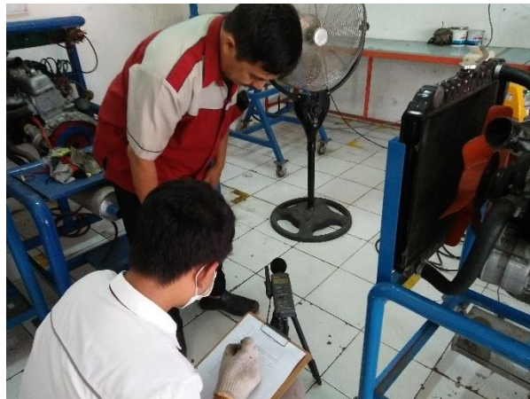
Gambar 7. Pengujian Kebisingan Mesin Toyota Kijang Tipe 7K
