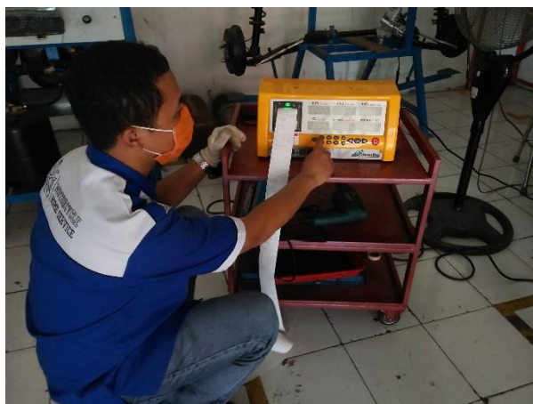
Gambar 6. Pengujian Emisi Gas Buang Mesin Toyota Kijang Tipe 5K
