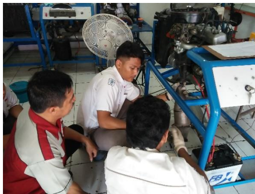
Gambar 2. Pemasangan Metallic Catalytic Converter Tembaga Berlapis Krom ke dalam Knalpot Mesin Toyota Kijang Tipe 7K
