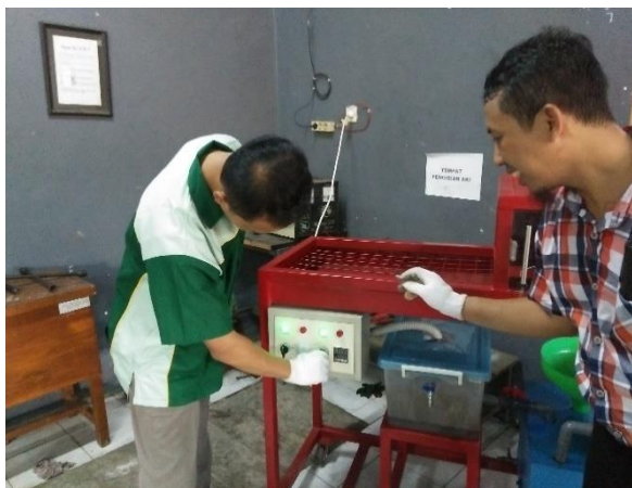
Gambar 2. Mengatur Timer Pompa Air Pada Oil Filter Cleaner
