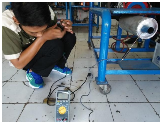
Gambar 3. Pemasangan Digital Thermometer Untuk Mengukur Suhu Gas Buang
