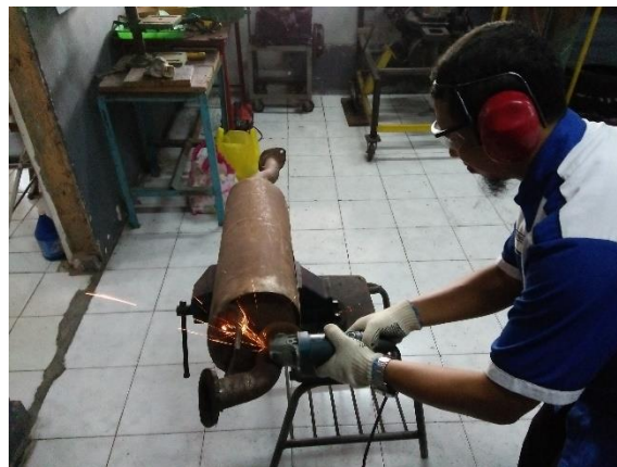
Gambar 3. Penghalusan Sambungan Elbow
