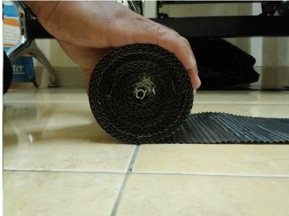
Gambar 10. Penggulungan Lekukan Plat Tembaga Berlapis Krom Sebagai Metallic Catalytic Converter
