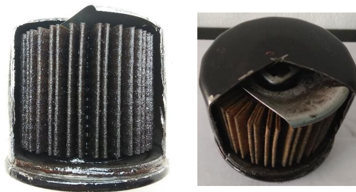
Gambar 130. Kondisi Saringan Oli Mesin Bekas ( Used Oil Filter ): (a) Sebelum Pembersihan, (b) Setelah Pembersihan Dengan Menggunakan Oil Filter Cleaner Selama 10 Menit Dengan Temperatur Air 80°C dan Tekanan Air 0,7 kg/cm 2
