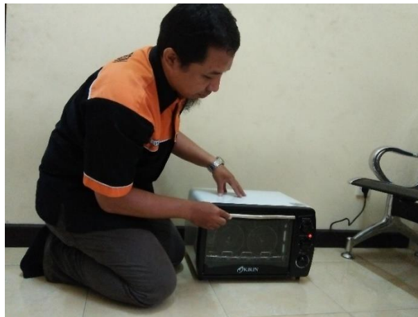
Gambar 14. Proses Kalsinasi Metallic Catalytic Converter Plat Kuningan Pada Temperatur 120°C Selama 12 Jam dan 550°C Selama 6 Jam
