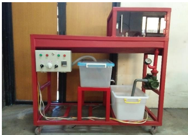
Gambar 163. Bak Plastik Penampung Air Pada Oil Filter Cleaner
