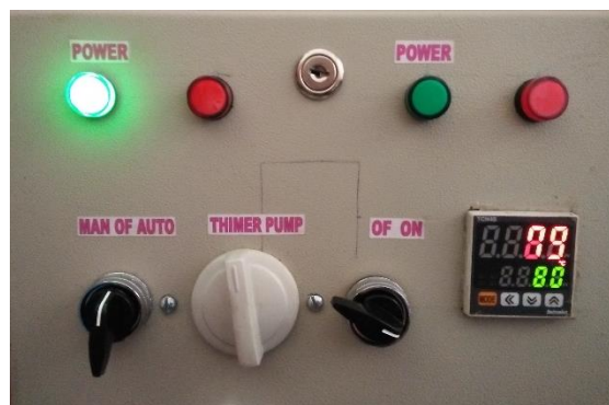
Gambar 109. Mengatur Electronic Temperature Controller Pada Temperatur 80°C
