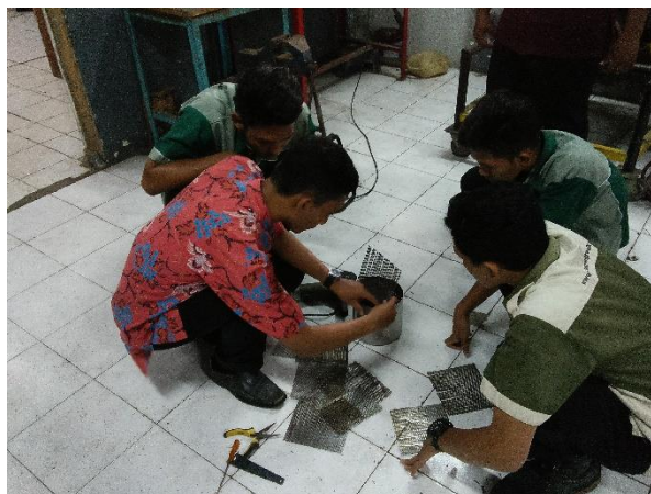
Gambar 6. Merangkai DPF ke dalam Tabung
