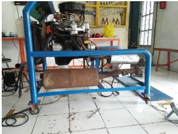
Gambar 161. Off-set Tube Type Muffler dan Muffler Standar Mesin Toyota Kijang Tipe 5K di SMK Semen Gresik Sebelum Pengecatan
