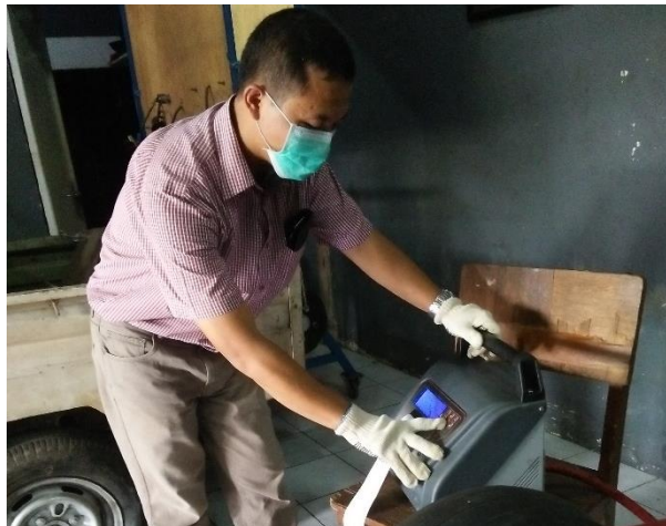
Gambar 5. Mengukur Opasitas Gas Buang Mesin Isuzu C190
