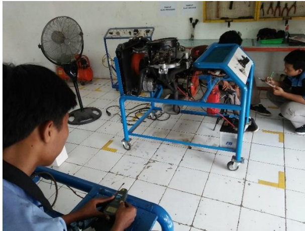
Gambar 4. Mengukur Putaran Mesin Dengan Menggunakan Digital Tachometer
