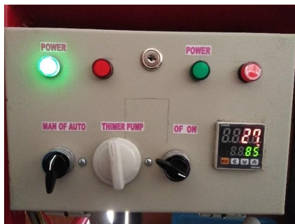
Gambar 3. Mengatur Temperatur Pembersihan Oil Filter Bekas Sebesar 85°C
