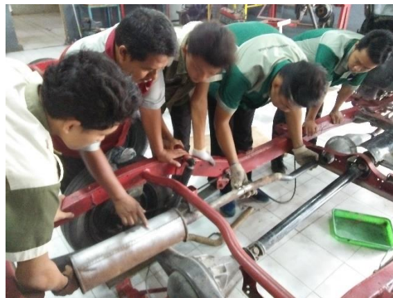
Gambar 2. Memasang Knalpot Mobil Diesel Isuzu C190
