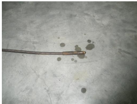
Gambar 115. Uap Air ( \text{H}_2\text{O} ) yang Terdapat Pada Gas Probe Tanpa Pemakaian Metallic Catalytic Converter di Knalpot Standar
