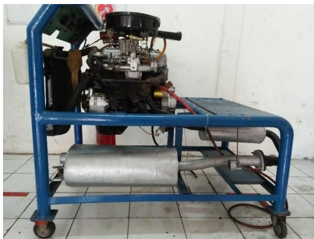
Gambar 162. Off-set Tube Type Muffler dan Muffler Standar Mesin Toyota Kijang Tipe 5K di SMK Semen Gresik Setelah Pengecatan
