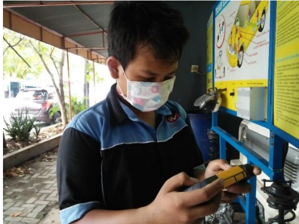
Gambar 4. Mengukur Putaran Mesin Dengan Menggunakan Digital Tachometer
