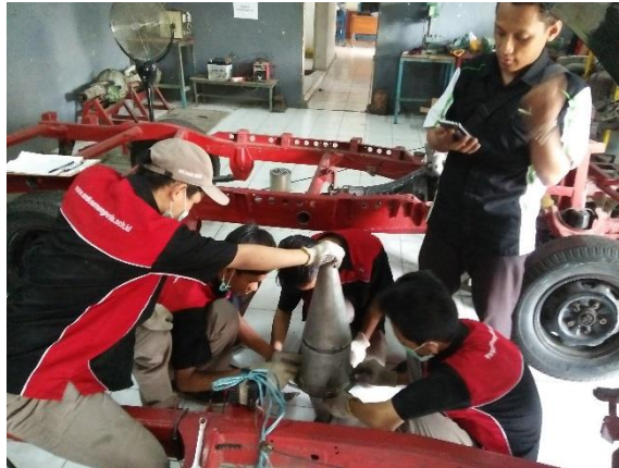
Gambar 1. Memasukkan DPF Stainless Steel + 150 gr Glasswool ke dalam Casing
