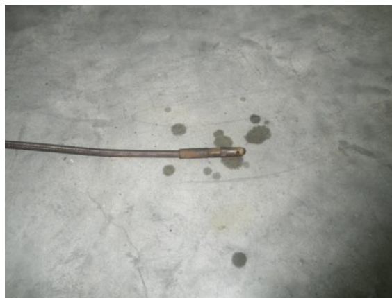
Gambar 88. Uap Air ( \text{H}_2\text{O} ) yang Terdapat Pada Gas Probe Tanpa Pemakaian Metallic Catalytic Converter di Knalpot Standar
