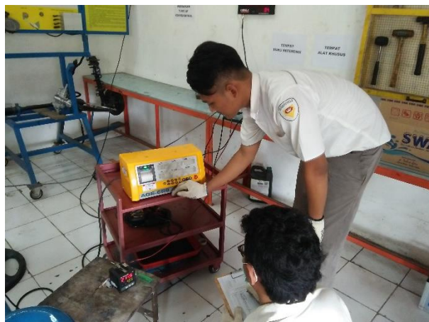
Gambar 5. Pengujian Temperatur Gas Buang Mesin Toyota Kijang Tipe 7K
