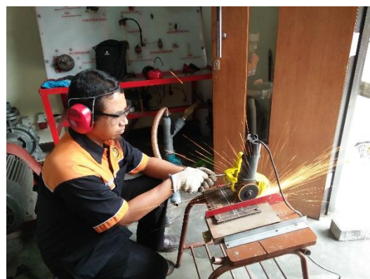
Gambar 3. Membuat Alur Dengan Jarak 10 mm Pada Plat Perforated Stainless Steel (Fe+Cr)
