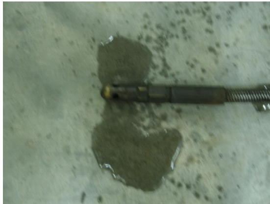
Gambar 142. Uap Air (H 2 O) yang Terdapat Pada Gas Probe Setelah Penggunaan Metallic Catalytic Converter Plat Tembaga Berlapis Krom di Knalpot Eksperimen
