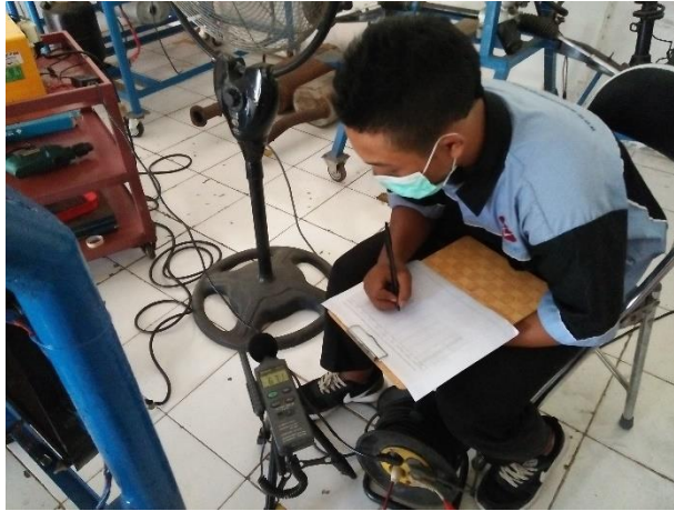
Gambar 4. Pengujian Kebisingan Mesin Toyota Kijang Tipe 5K
