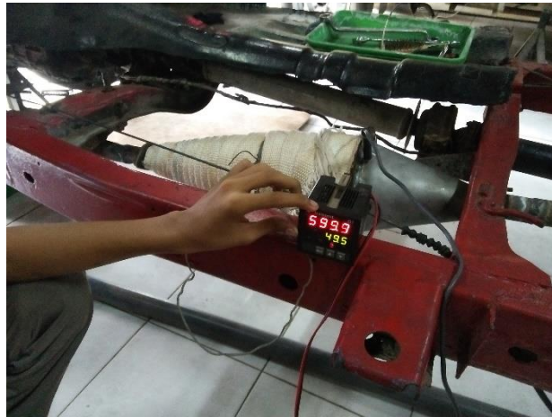
Gambar 4. Mengukur Temperatur Gas Buang Dengan Digital Thermometer
