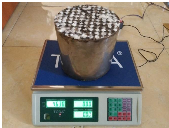
Gambar 8. Menimbang DPF Pada Timbangan Digital
