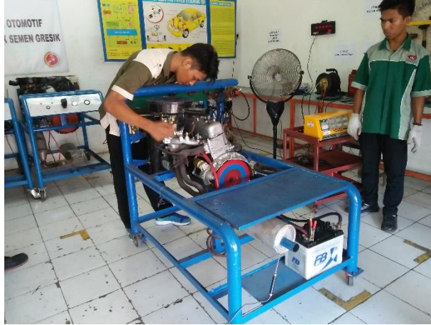
Gambar 4. Mengukur Putaran Mesin Dengan Menggunakan Digital Tachometer
