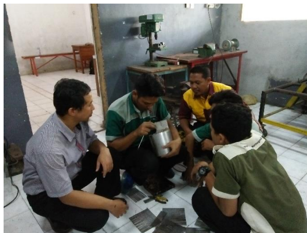
Gambar 6. Merangkai DPF ke dalam Tabung
