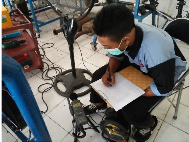
Gambar 4. Pengujian Kebisingan Mesin Toyota Kijang Type 5K
