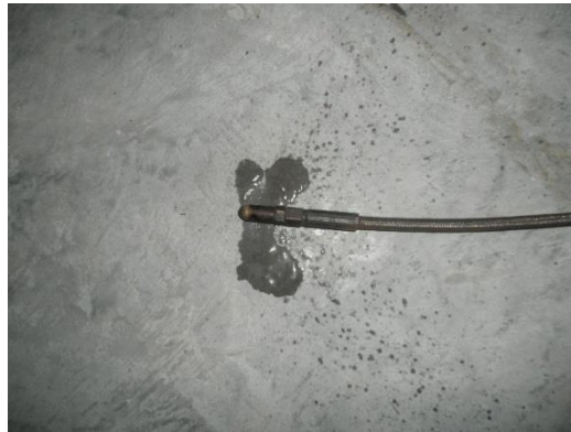
Gambar 116. Uap Air (H 2 O) yang Terdapat Pada Gas Probe Setelah Penggunaan Metallic Catalytic Converter Plat Tembaga (Cu) di Knalpot Eksperimen
