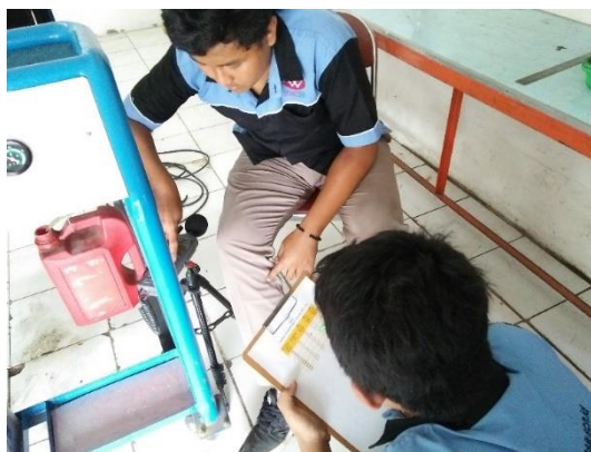
Gambar 3. Mengukur Tingkat Kebisingan Knalpot Standar Dengan Menggunakan Sound Level Meter (SLM)
