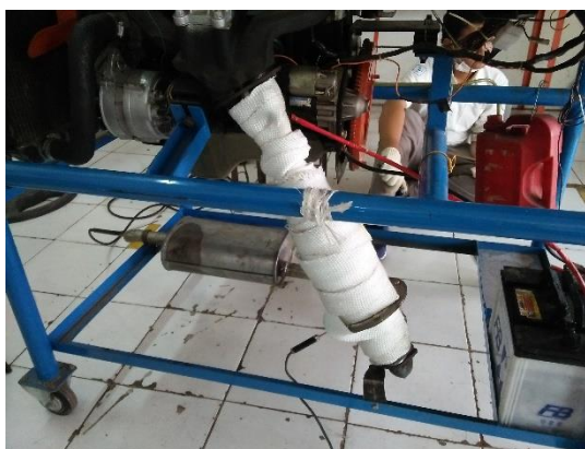
Gambar 3. Pemasangan Exhaust Wrap Pada Knalpot Mesin Toyota Kijang Tipe 7K
