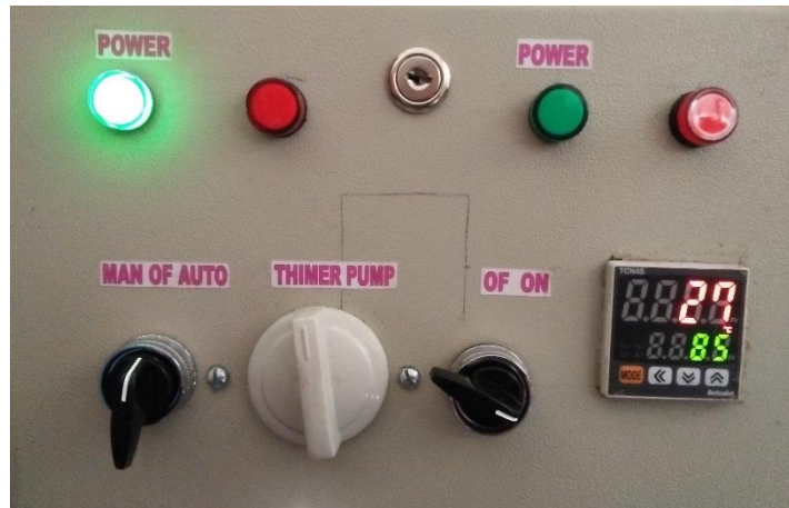
Gambar 135. Mengatur Electronic Temperature Controller Pada Temperatur 85°C
