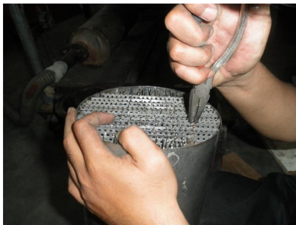
Gambar 6. Merangkai DPF ke dalam Tabung
