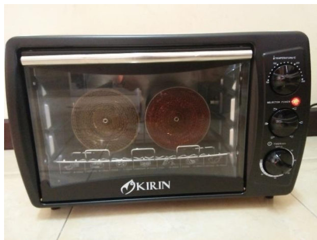
Gambar 14. Proses Kalsinasi Metallic Catalytic Converter Plat Tembaga Pada Temperatur 120°C Selama 12 Jam dan 550°C Selama 6 Jam
