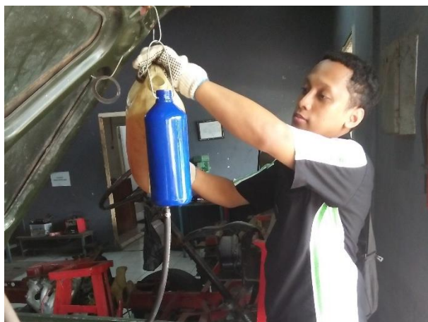
Gambar 6. Mengukur Konsumsi Bahan Bakar Mesin Isuzu C190
