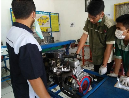
Gambar 1. Penyetelan Timing Pengapian Mesin Toyota Kijang Tipe 5K
