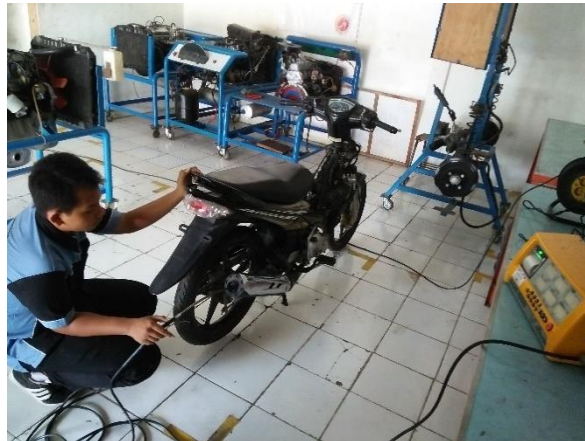
Gambar 1. Uji Emisi Gas Buang Knalpot Standar Yamaha Jupiter MX
