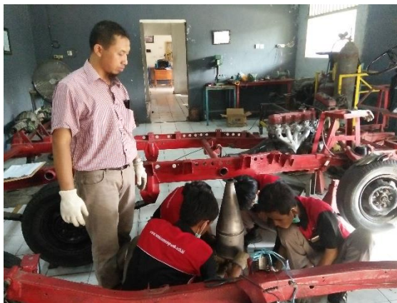
Gambar 2. Mengencangkan Baut Pengikat DPF Casing
