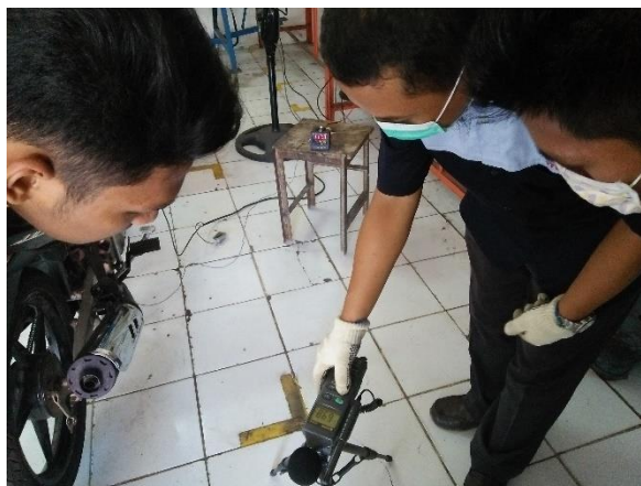
Gambar 3. Uji Tingkat Kebisingan Knalpot Sepeda Motor Yamaha Jupiter MX
