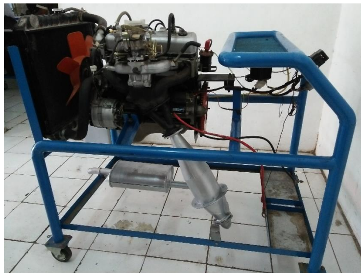
Gambar 158. Metallic Catalytic Converter Casing dan Muffler Mesin Toyota Kijang Tipe 7K di SMK Semen Gresik Setelah Pengecatan
