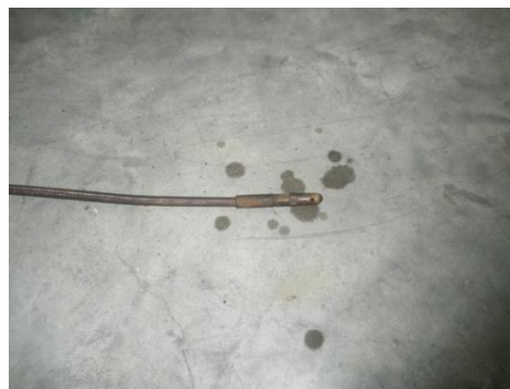
Gambar 141. Uap Air ( \text{H}_2\text{O} ) yang Terdapat Pada Gas Probe Tanpa Penggunaan Metallic Catalytic Converter di Knalpot Standar
