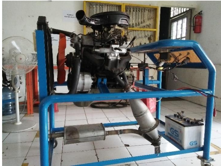
Gambar 157. Metallic Catalytic Converter Casing dan Muffler Mesin Toyota Kijang Tipe 7K di SMK Semen Gresik Sebelum Pengecatan
