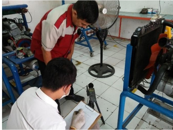
Gambar 7. Pengujian Kebisingan Mesin Toyota Kijang Tipe 7K
