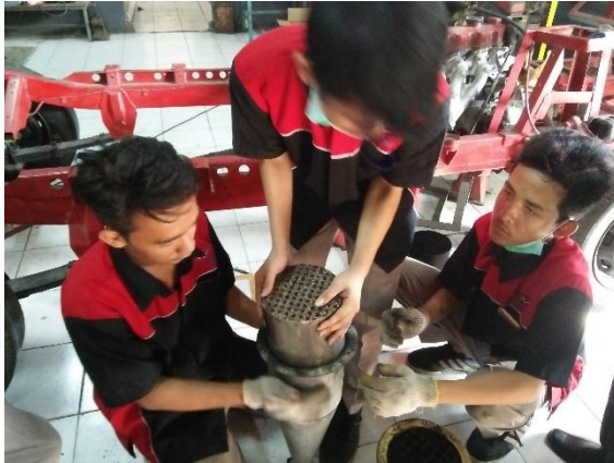
Gambar 1. Memasukkan DPF Stainless Steel + 130 gr Glasswool ke dalam Casing
