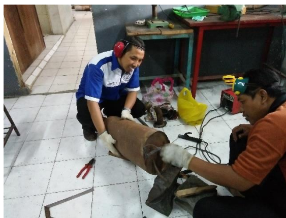
Gambar 3. Pembuatan Dudukan Muffler
