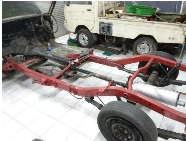
Gambar 159. DPF Casing dan Muffler Mesin Isuzu C190 di SMK Semen Gresik Sebelum Pengecatan
