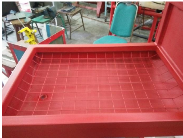
Gambar 8. Tempat Menaruh Oil Filter Bekas yang Telah Dibersihkan Dengan Oil Filter Cleaner
