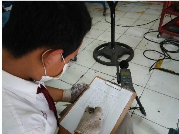
Gambar 7. Pengujian Kebisingan Mesin Toyota Kijang Tipe 7K
