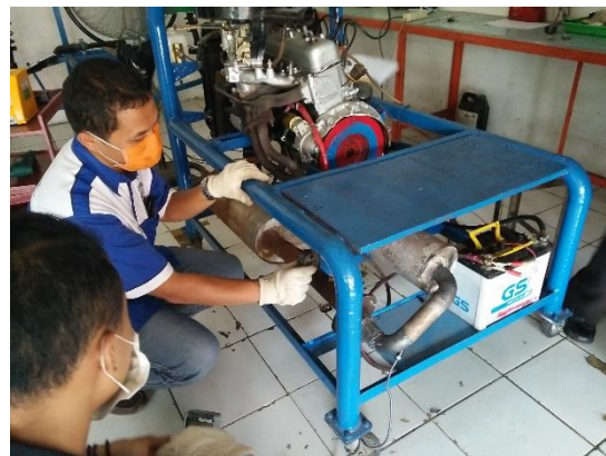
Gambar 2. Pemasangan Karet Peredam Pada Knalpot
