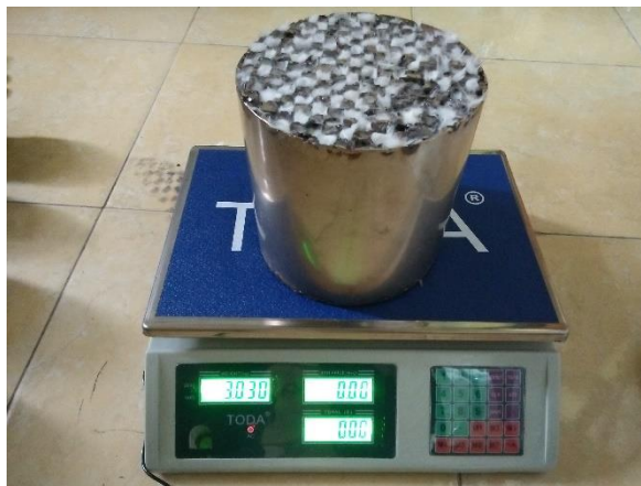
Gambar 8. Menimbang DPF Pada Timbangan Digital
