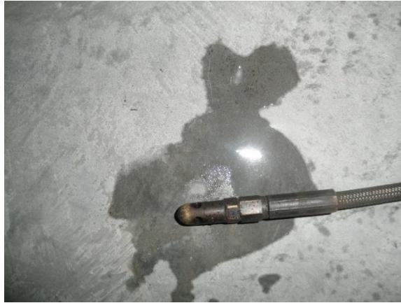
Gambar 89. Uap Air (H 2 O) yang Terdapat Pada Gas Probe Setelah Penggunaan Metallic Catalytic Converter Plat kuningan (Cu+Zn) di Knalpot Eksperimen
