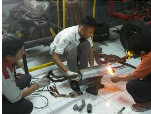
Gambar 1. Proses Penyambungan Pipa Knalpot
