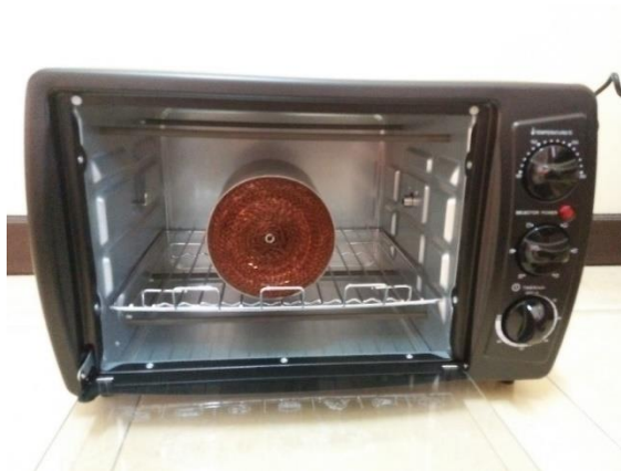
Gambar 13. Proses Kalsinasi Metallic Catalytic Converter Plat Tembaga Pada Temperatur 100°C Selama 30 Menit
