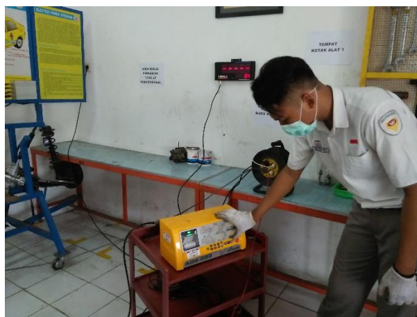
Gambar 6. Pengujian Emisi Gas Buang Mesin Toyota Kijang Tipe 7K
