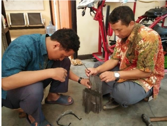
Gambar 4. Merangkai Plat Perforated Stainless Steel yang Telah Diberi Alur
