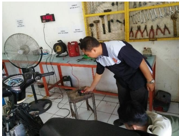
Gambar 2. Uji Temperatur Gas Buang
