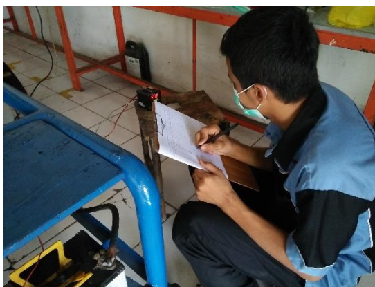
Gambar 3. Pengukuran Temperatur Gas Buang Pada Knalpot Mesin Toyota Kijang Tipe 5K
