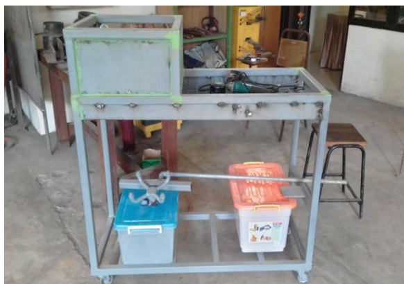
Gambar 6. Instalasi Bak Penampung Air dan Bak Penampung Limbah Oli
