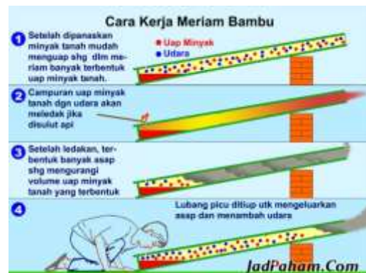
Gambar 7. Cara kerja meriam bambu
